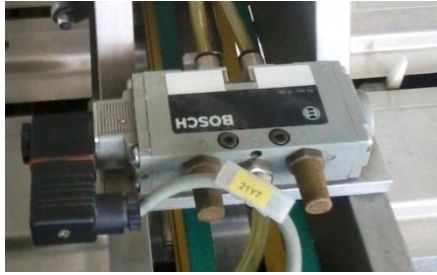
Figure I.20: Image réel du distributeur 5/2
