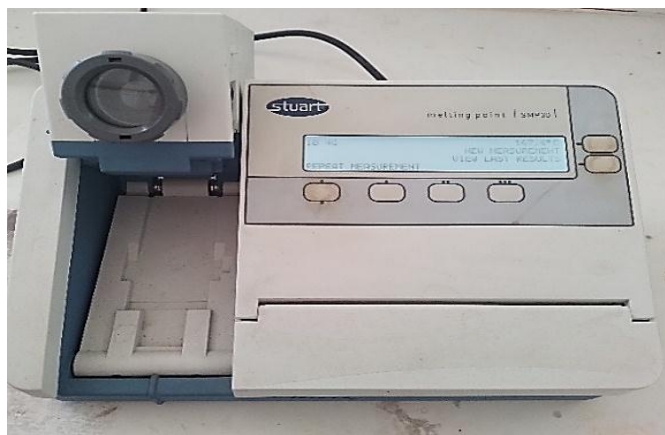
Figure 2.2: Appareil fusiomètre à capillaire utilisés pour déterminer le point de fusion.
