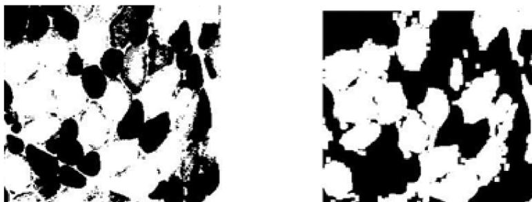
**Fig. 2.5.** Exemple d'ouverture sur une image binaire.
