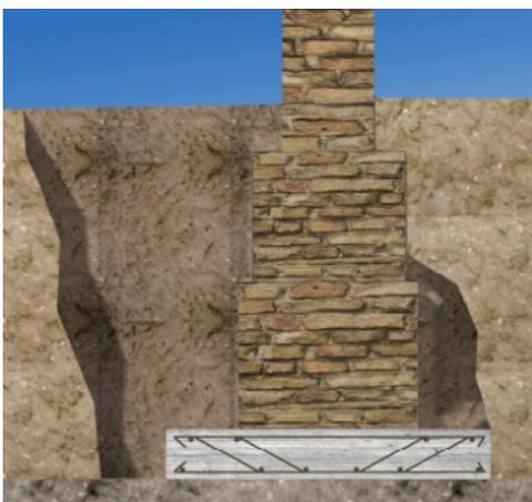
Figure 4.12 : stabilisation du mur par élargissement de la semelle après étaielement.
