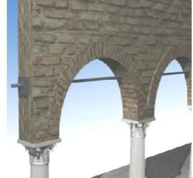
**Figure 4.36:** système de réglage périodique du tirant
