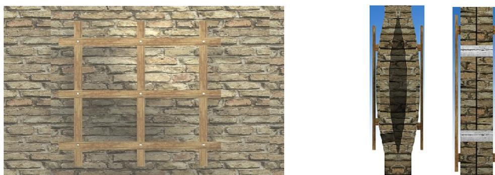
Figure 4.40 : Pose de boutisse après réduction du bouffement par étalement.
