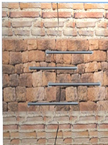
**Figure 4.30:** Epingle protégée ancré dans le mur pour renforcement
