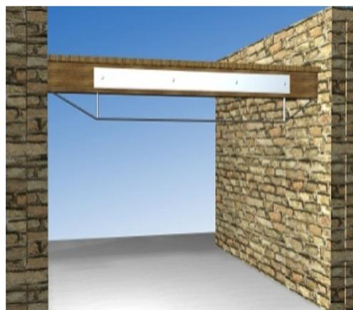
**Figure 4.19:** Redressement de la poutre par sa mise en tension.
