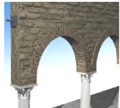
**Figure 4.37 :** Système de réglage périodique du tirant. En haut dans le mur
