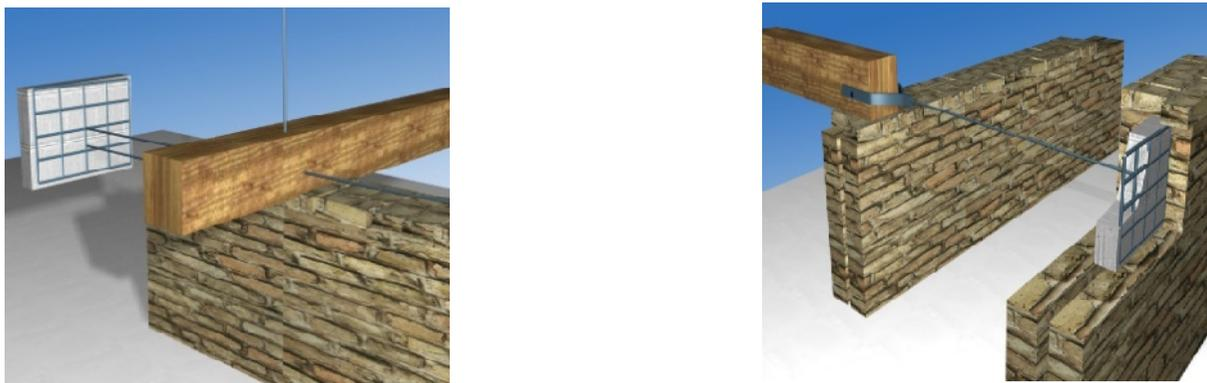
**Figure 4.45** : Renforcement et consolidation des murs et des structures portées par des tirants d'ancrages.
