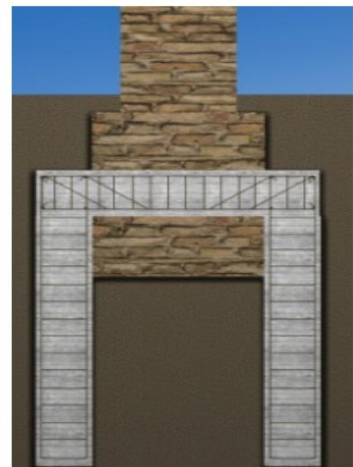
**Figure 4.15:** Procédé de pieux adhérent accolé des deux côtés du mur de fondation
