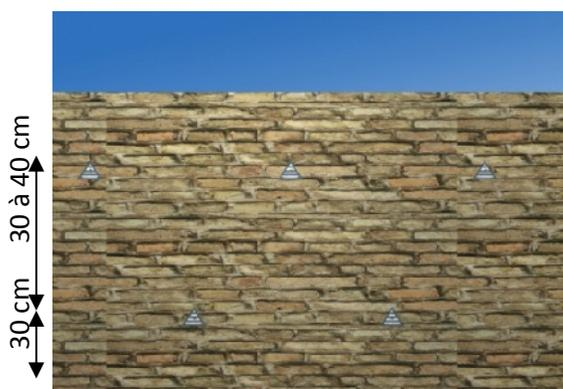
**Figure 4.2:** Assèchement du mur par prismes munis de grilles encastées
