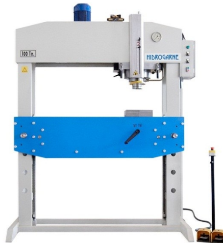
Figure III 4 : Presse à montants
