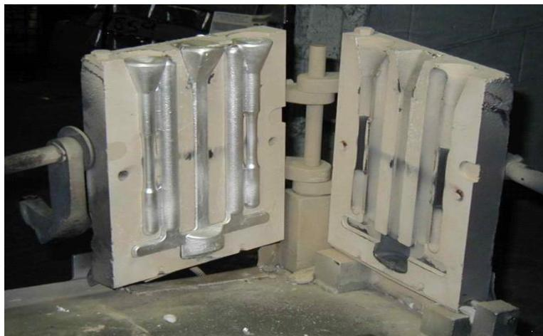
Figure II.2: Moule permanent STAHL ASTM B-108 pour la coulée des éprouvettes de traction.
