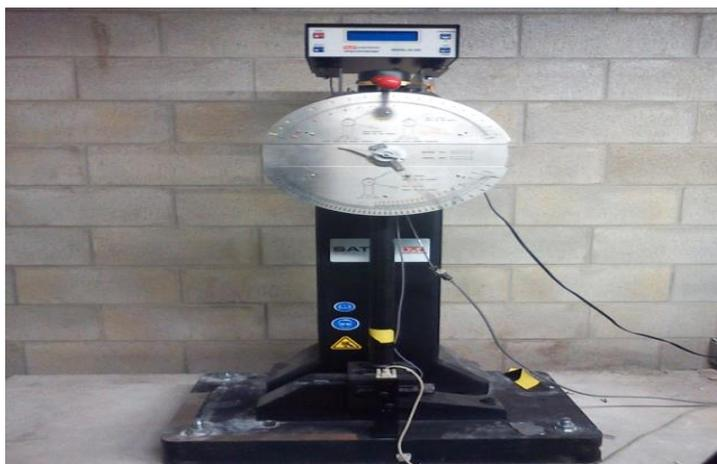
Figure II.7: Mouton pendule SATEC SI-1 utilisé pour les essais d'impact.
