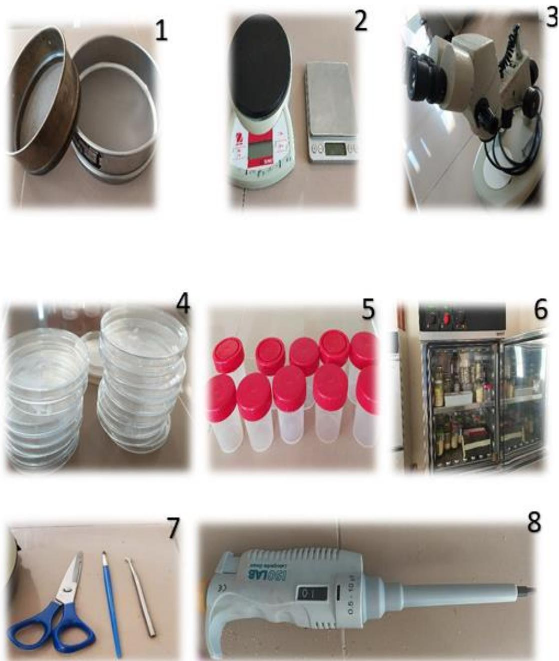
**Figure 14.** Matériel expérimental utilisé (1 : Tamis, 2 : Balance électronique, 3 : Loupe binoculaire, 4 : Boîtes de Pétri, 5 : Boîtes en plastiques, 6 : Etuve obscure, 7 : Autres accessoires, 8 : Micropipette) (Originelle, 2022).
