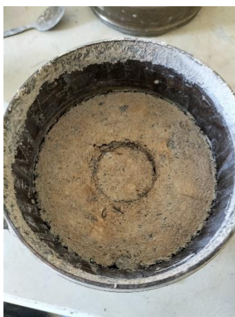
Figure VI.4 : Epreuve après poinçonnement.
