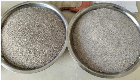
Figure IV.3 : Classes 1-0.5 et 0.5-0.063 du matériau utilisé
