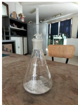
Figure IV.5 : Pycnomètre en verre utilisé pour l'essai de la masse volumique
