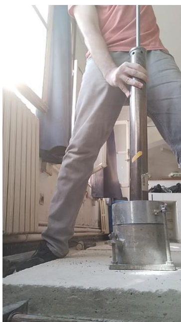
Figure V.10 : Compactage Proctor modifié Figure V.11 : Moule Proctor modifié après compactage
