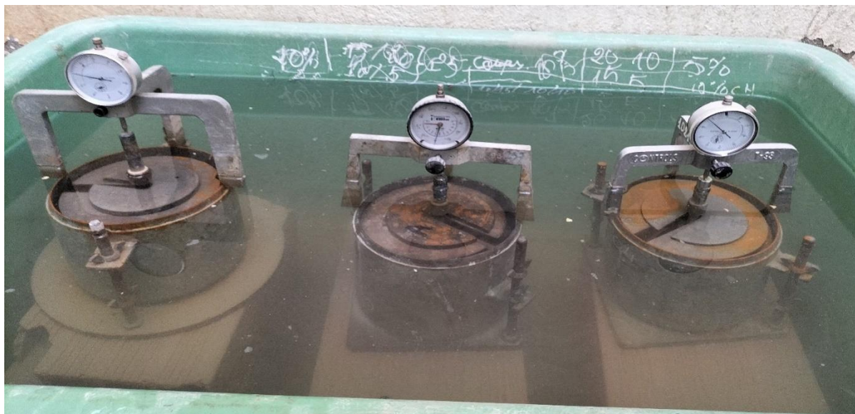
Figure VI.2: Imbibition et gonflement (CBR après immersion).
