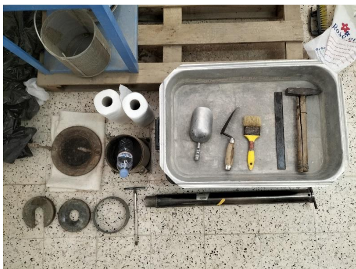
Figure VI.1 : Tout le matériel de confection des éprouvettes (CBR).
