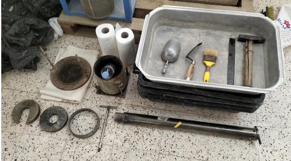
Figure V.9 : Tout l'appareillage utilisé pour les compactages Proctor.
