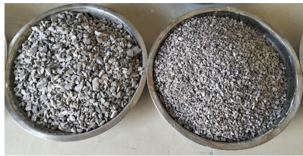
Figure IV.2 : Classes 10-4 et 4-2 du matériau utilisé
