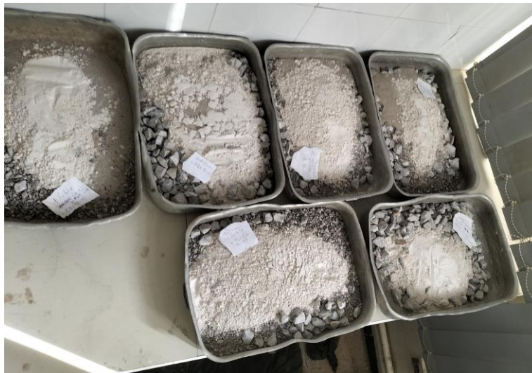
Figure V.12 : Quelques bacs de GNT pesés s'apprêtant à être mélangés, humidifiés et compactés
