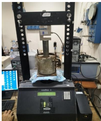
Figure VI.3 : CBR Geocomp Load Trac II servant à poinçonner les éprouvettes (CBR).
