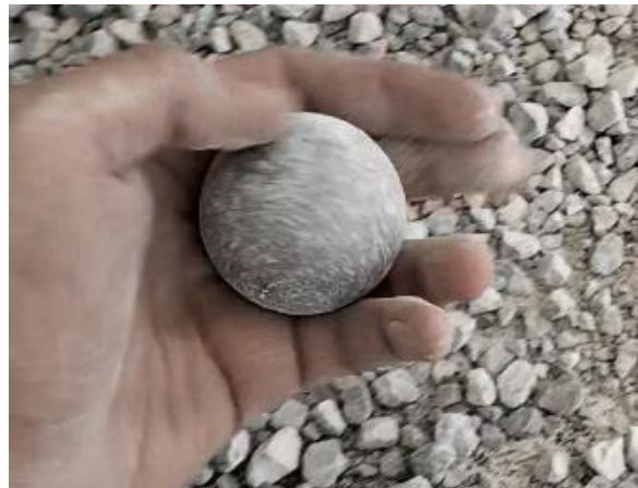
Figure IV.7 : Une des boules utilisée pour la charge Los Angeles
