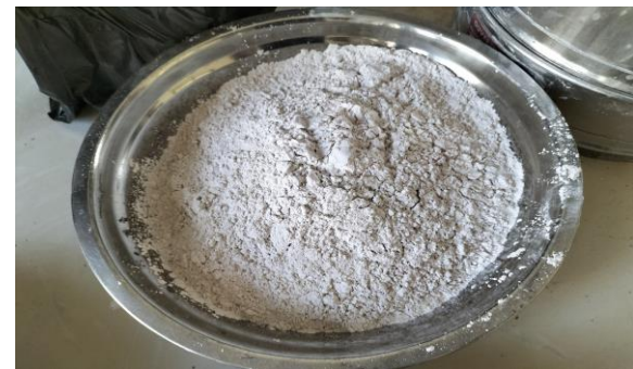
Figure IV.4 : Fines (0.063-0) du matériau utilisé
