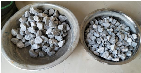
Figure IV.1 : Classes 25-20 et 20-10 du matériau utilisé
