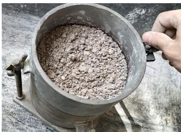
Figure V.10 : Compactage Proctor modifié Figure V.11 : Moule Proctor modifié après compactage
