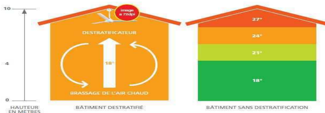
Figure IV.32 : déstratificateur d'air . Source : https://www.edf.fr/entreprises/le-mag/le-mag-entreprises/conseils-energie-competitivite/pourquoi-s-equiper-d-un-destratificateur-d-air
