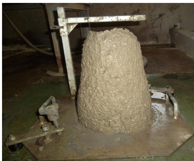
Figure 3.9 : Mesure d'affaissement du béton au cône d'Abrams.
