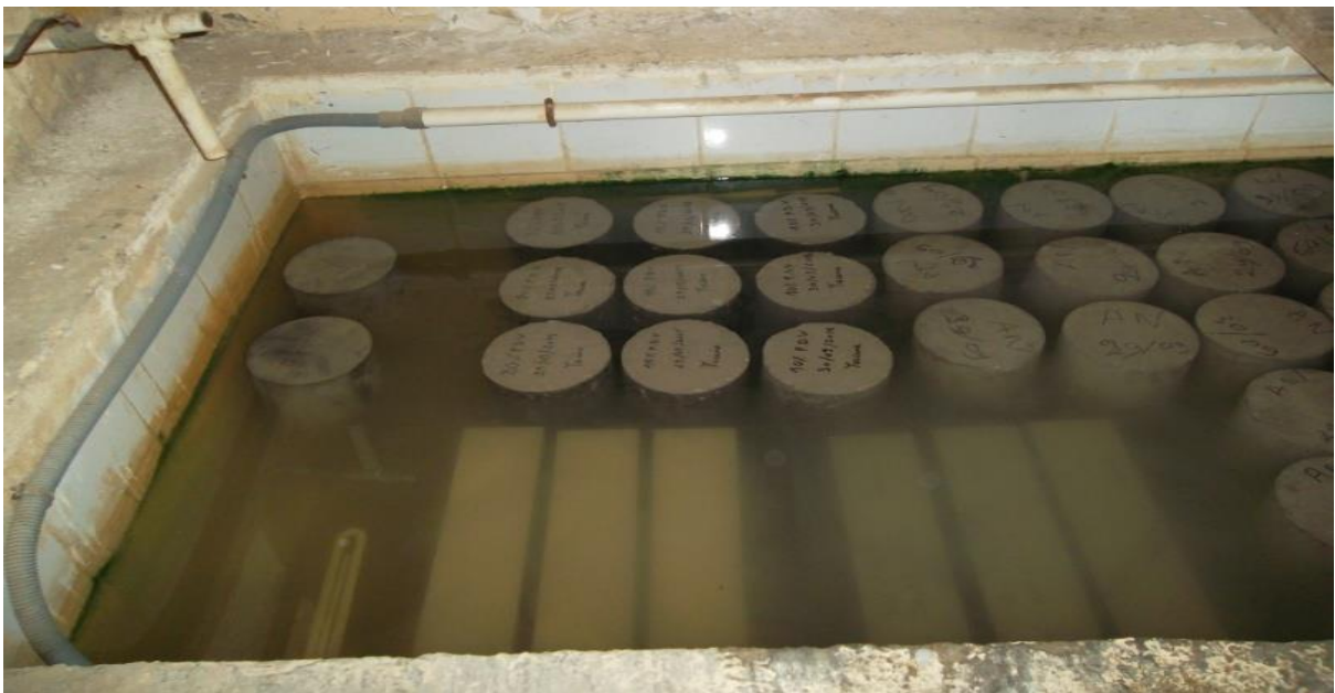
Figure 3.11 : Éprouvettes conservées dans un bain à 20°C durant 28 jours.
