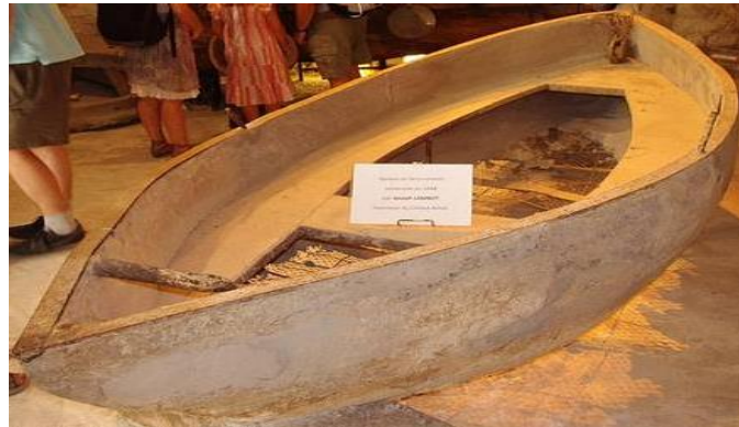
Figure 1.1 : La barque de Joseph Lambot, réalisée en 1849.
