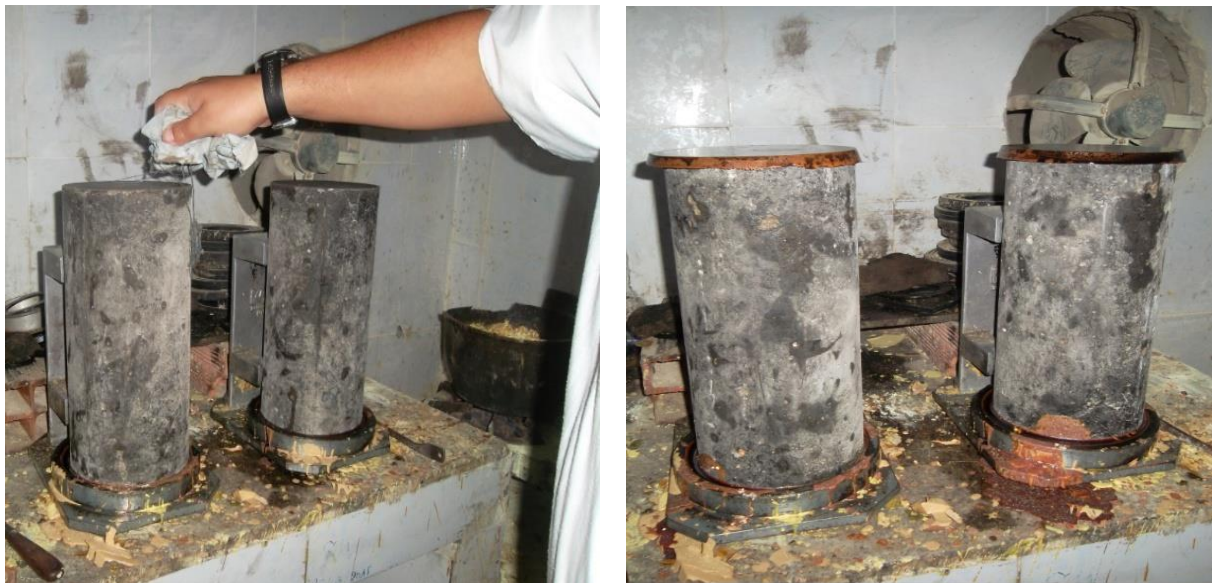
Figure 3.12 : Surfaçage de l'éprouvette par le souffre et le sable.
