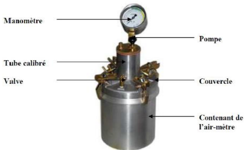
Figure 2.6 : Appareillage air mètre.
