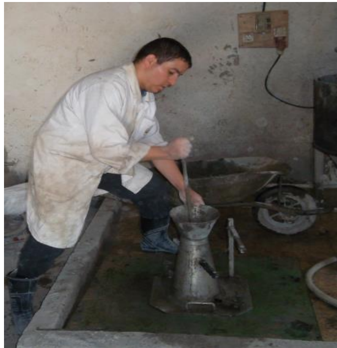
Figure 3.8 : Piquage des couches du béton dans le cône d'Abrams.
