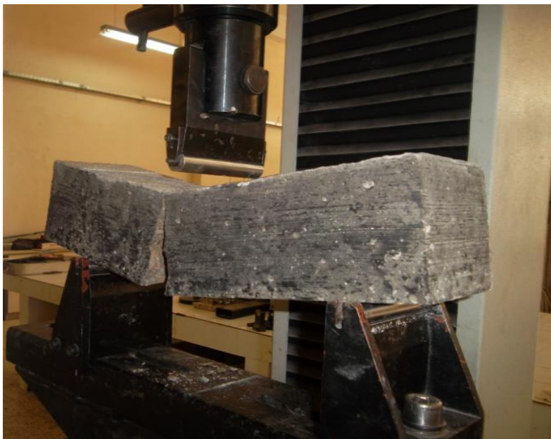
Figure 3.15 : Éprouvette prismatique rompue suite l'essai de traction par flexion à 3 points.
