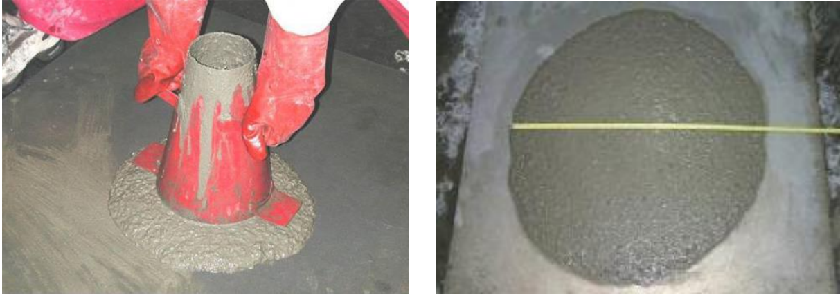
Figure 2.4 : Essai d'étalement d'un béton autoplaçant.
