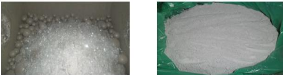
Figure 2.11 : Broyage des débris de verre.
