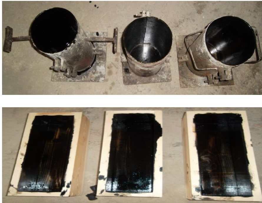
Figure 3.6 : Moules des éprouvettes cylindriques et prismatiques graissés à l'aide d'huile.
