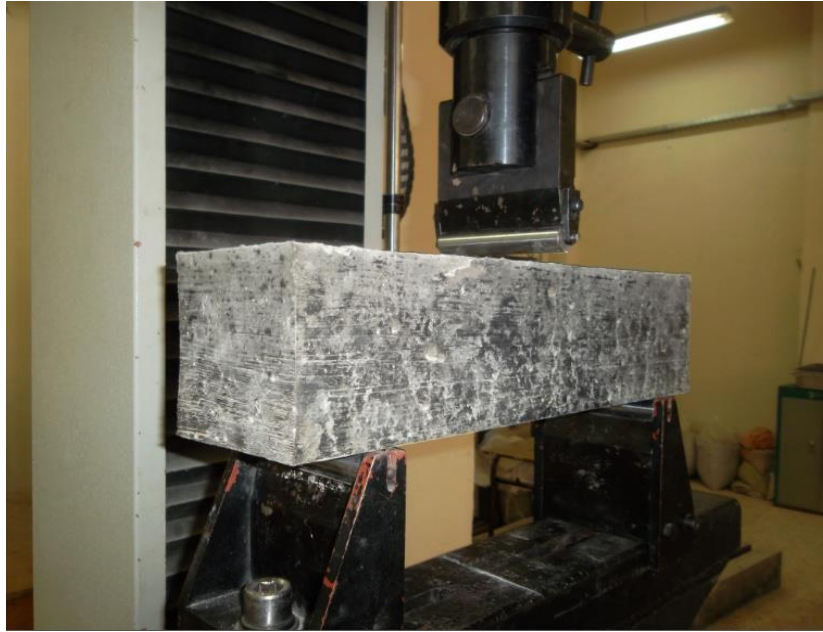
Figure 3.14 : Essai de traction par flexion à 3 points.
