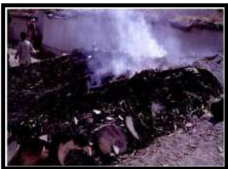
Fig. 7 : Cuisson en meule : du bois, de la bouse de vache et de la paille
