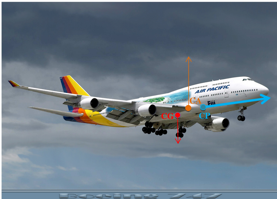
Figure III.9 : points d'application des forces agissant en vol
