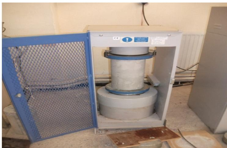
**Figure IV.11: Presse hydraulique utilisée pour les essais de compression**
