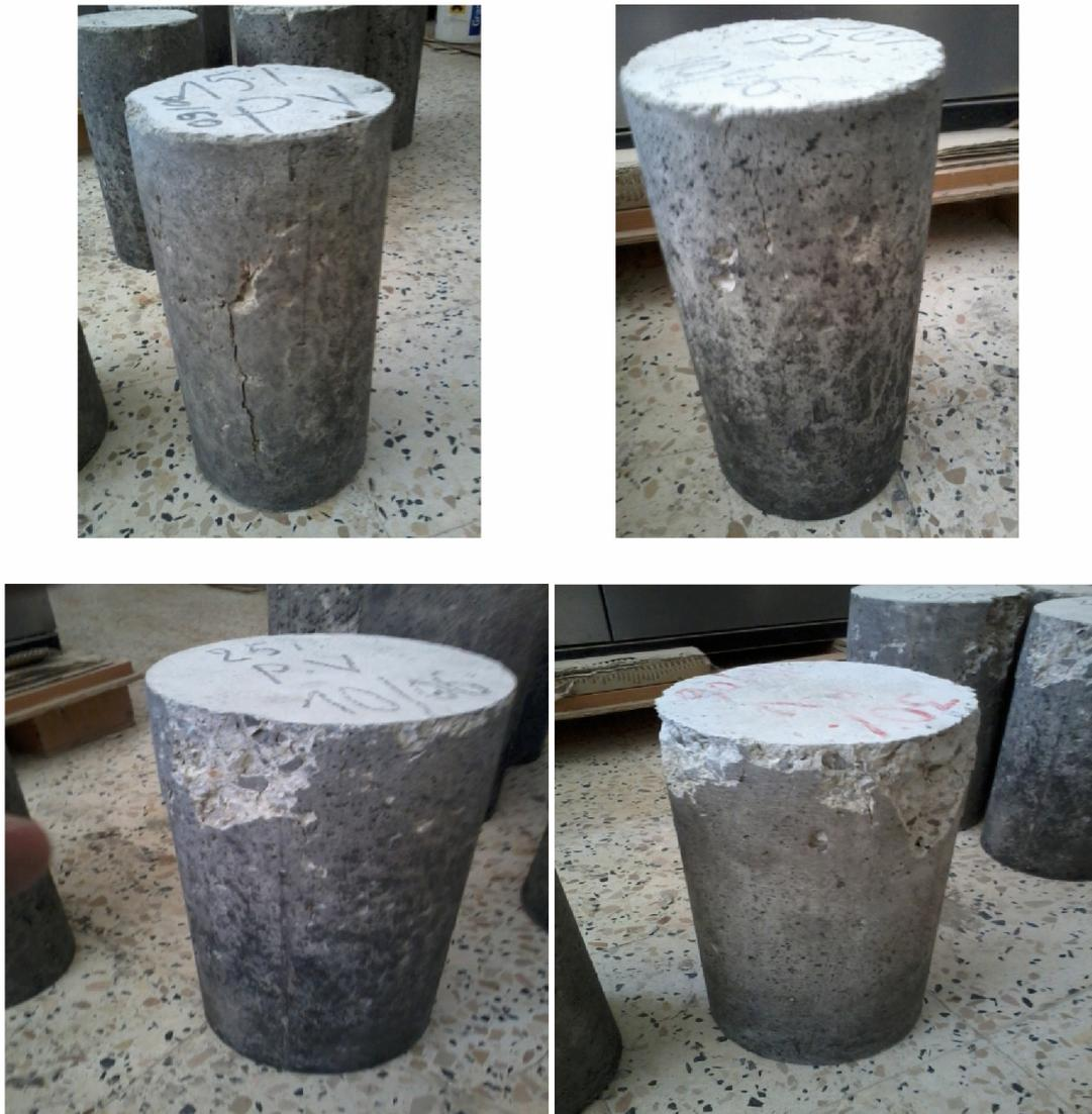
**Figure IV.12 : Eprouvettes après écrasement**
