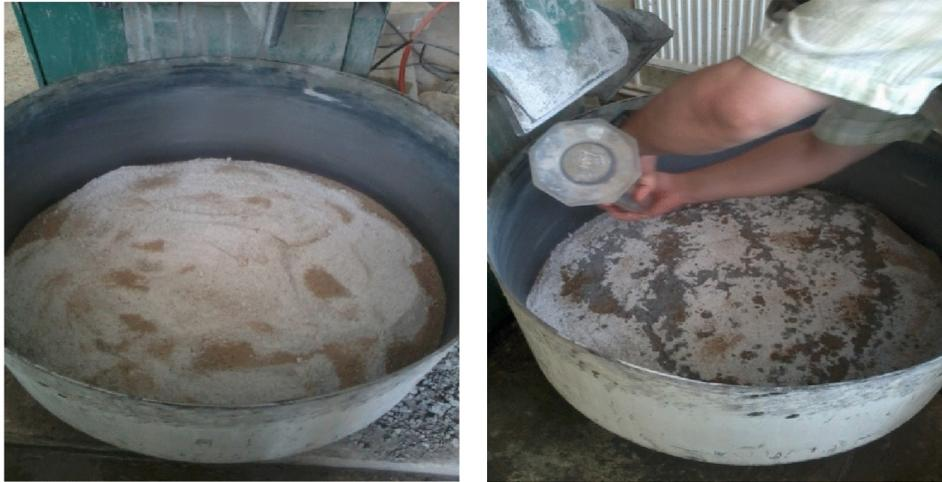
**Figure IV.5 : Foisonnement du mélange de la poudre de verre avec le sable.**
