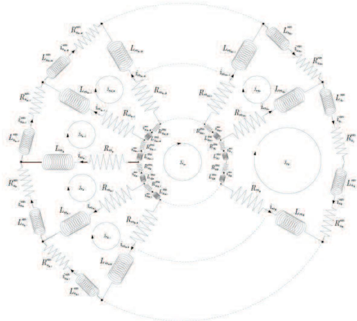
**Fig. 4.6 :** Circuits électriques adoptés pour la modélisation du rotor en présence d'une barre cassée
