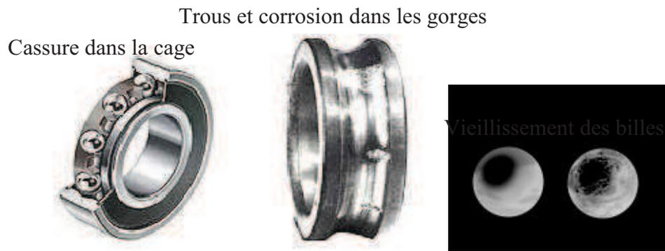
**Fig. 3.5** : Différentes défaillances des roulements à billes
