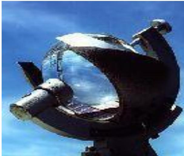
**Figure II.18 :** Héliographe permettant de mesurer la durée d'insolation.
