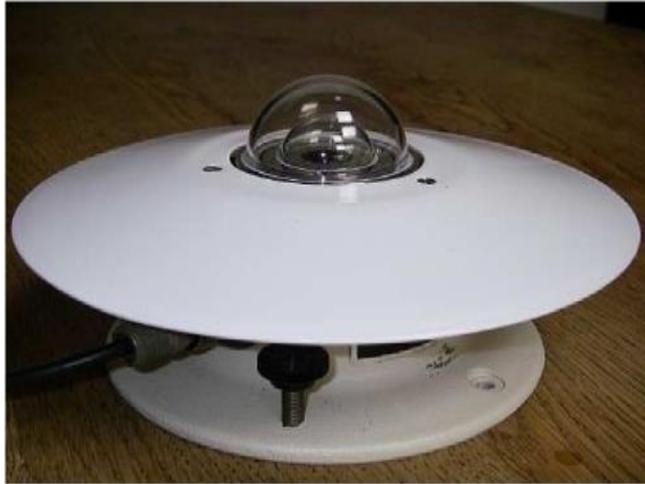
**Figure II.17 :** Pyranomètre donnant le rayonnement solaire global.
