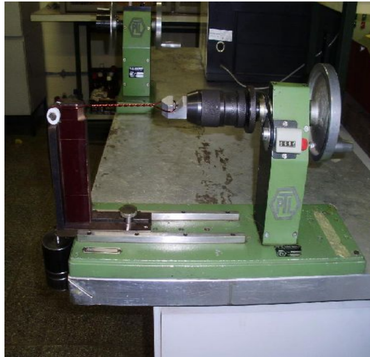
Figure IV.2. Tour à bobiner avec échantillon en cours de réalisation.
