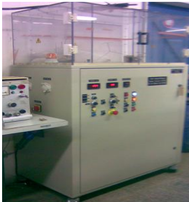
Figure IV.7. Générateur de haute tension utilisé pour les essais de claquage.
