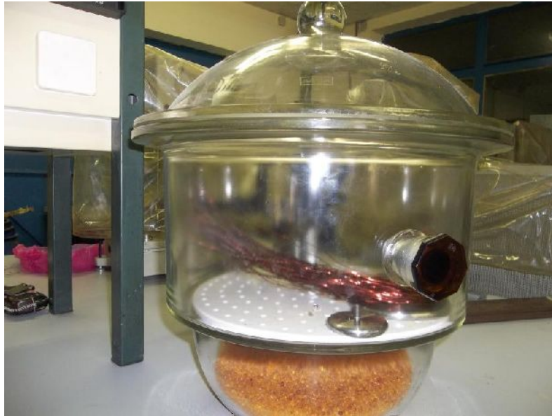
Figure IV.6 : Echantillons en cours de conditionnement dans un dessiccateur.
