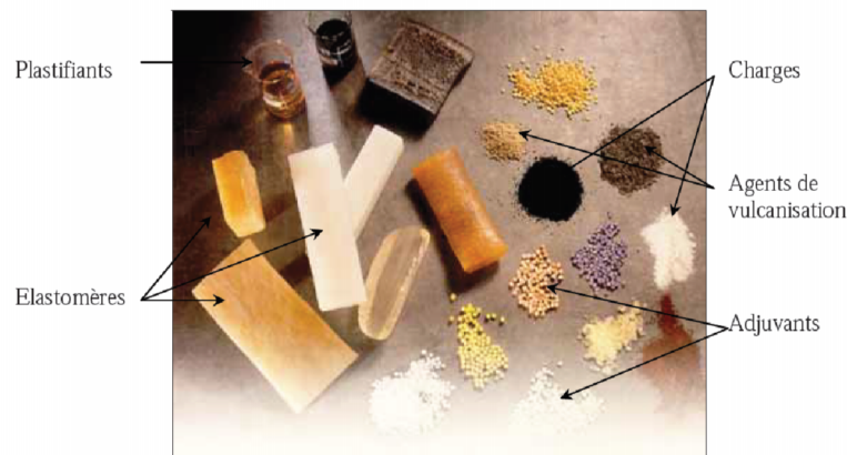
Figure I.2 : Composition d'un mélange de caoutchouc. [Kos]
