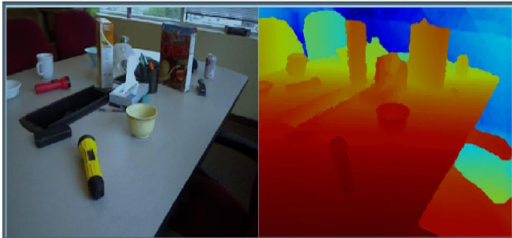
**Figure II.1 :** image RVB (à gauche) et la carte de profondeur correspondante (à droite) capturé avec une caméra **PrimeSense**. Les valeurs de profondeur vont de petites à grandes aussi que les changements de couleur du rouge au bleu.
