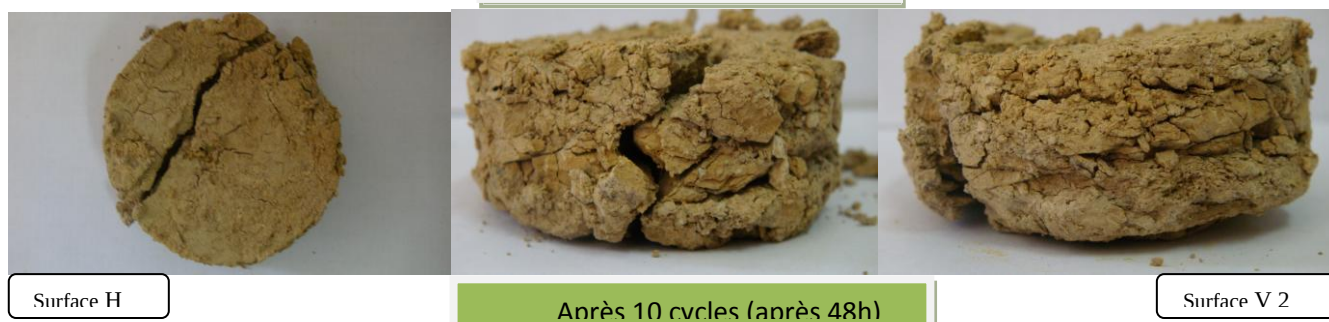
Figure B.6 : les images d'échantillon N°2 d'argile Centre ville(C.V), à état naturel, après étuve et après enceinte climatique.
