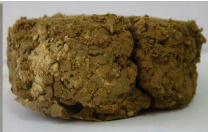
Figure B.4 : les images d'échantillon N°2 d'argile Fréha(F) à état naturel, après étuve et après enceinte climatique.
