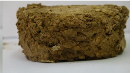
Figure B.4 : les images d'échantillon N°2 d'argile Fréha(F) à état naturel, après étuve et après enceinte climatique.
