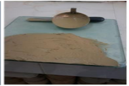
Figure IV.12 : Le remplissage de la coupelle de Casagrande
