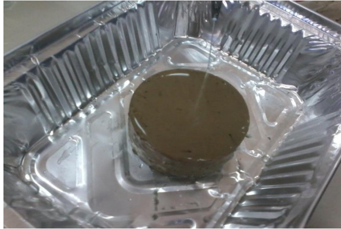
Figure V.8: Saturation des échantillons à l'aide d'une seringue.
