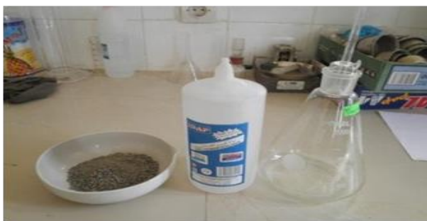
Figure IV.3 : Matériel d'essai au pycnomètre.
