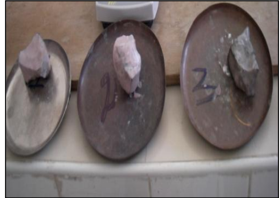
Figure IV.4 : Matériel d'essai de l'immersion dans l'eau.
