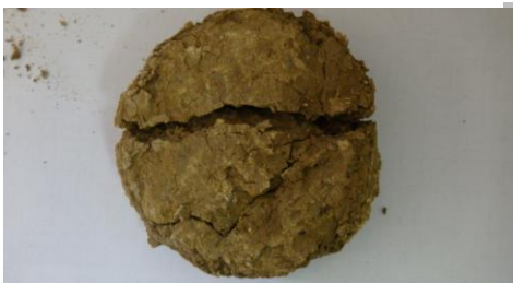
Figure B.4 : les images d'échantillon N°2 d'argile Fréha(F) à état naturel, après étuve et après enceinte climatique.
