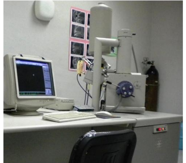
Figure IV.23: Le MEB utilise pour la réalisation des observations (MADJNOUN.A, 2014).
