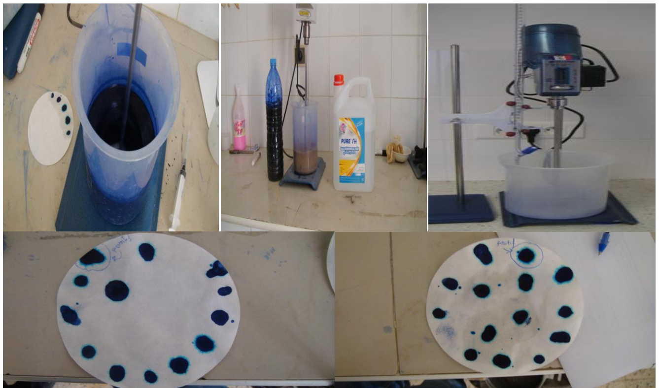
Figure IV.20: Matériel d'essai au bleu de méthylène (résultats de l'essai à la tâche).
