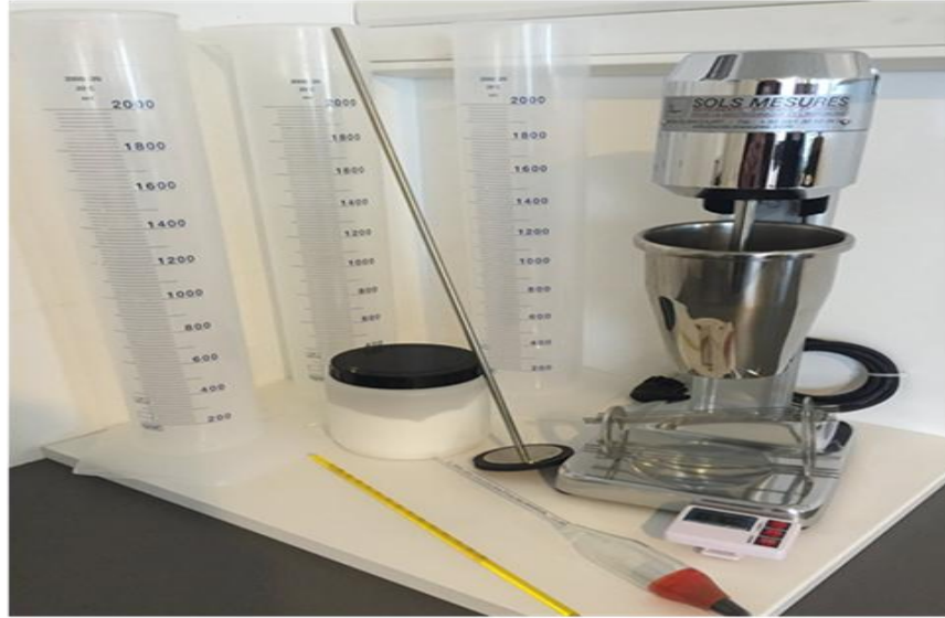
Figure IV.6: Matériel d'essai d'Analyse granulométrique par sédimentométrie
