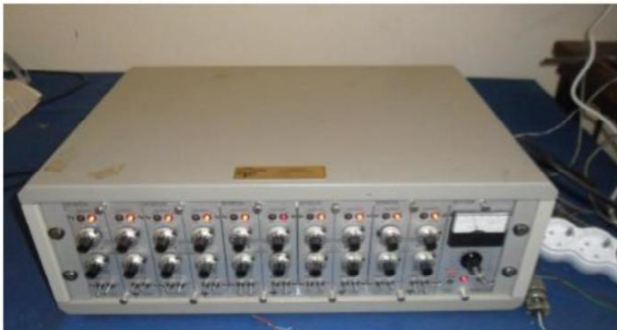
Figure IV.2 : Chaine d'acquisition « VISHAY MICROMESURE »
