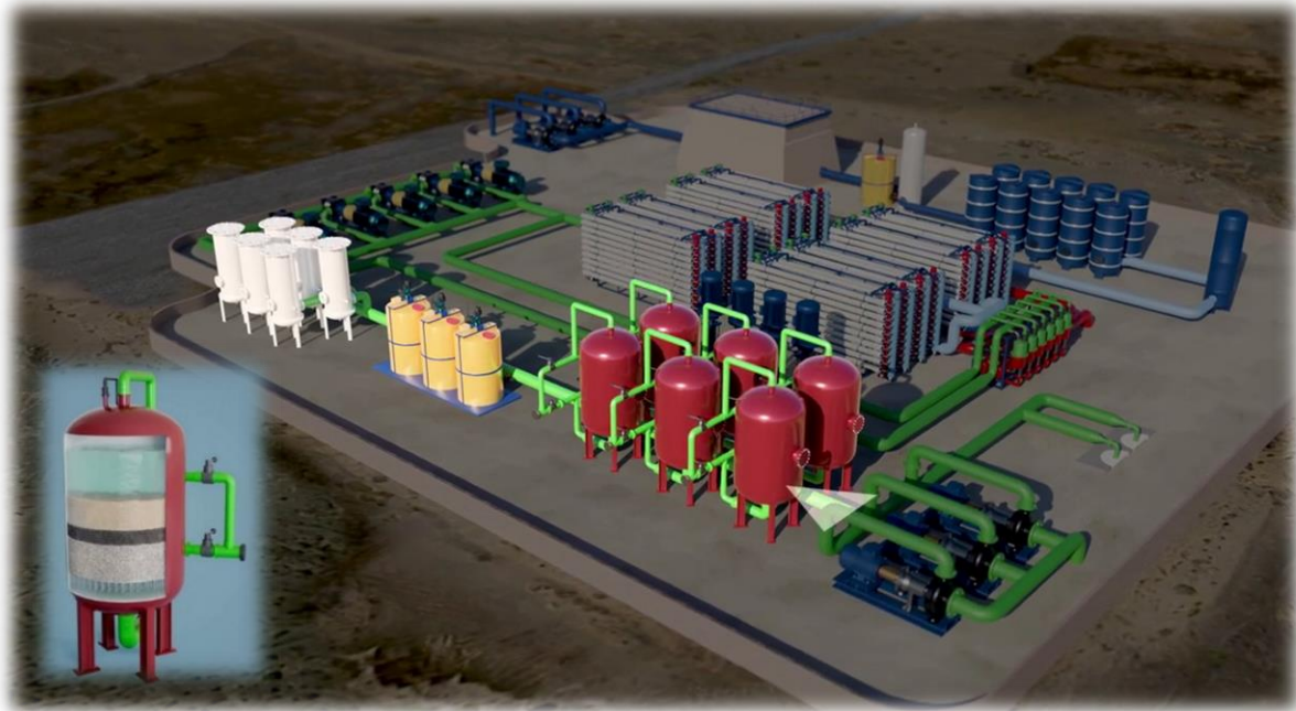
Figure I.17 : Prétraitement de l'eau [18].
