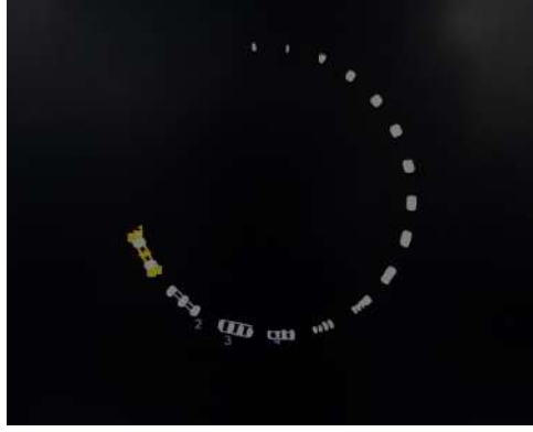
FIGURE 3.24 – Analyse de la résolution spatiale : Étude du module CTP528.
