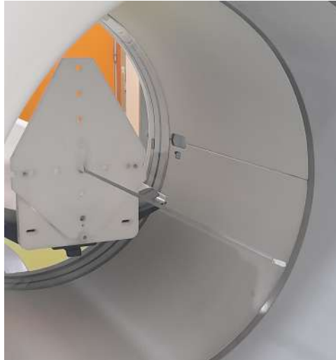
FIGURE 3.15 – Positionnement de la source linéaire pour le test de sensibilité au centre du FOV
