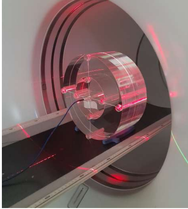
FIGURE 3.18 – Répartition des positions de mesure dans le fantôme dosimétrique en PMMA.
