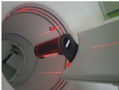
FIGURE 3.14 – Positionnement du fantôme ^{68}\text{Ge} Annulus DQA pour la calibration quotidienne des détecteurs TEP
