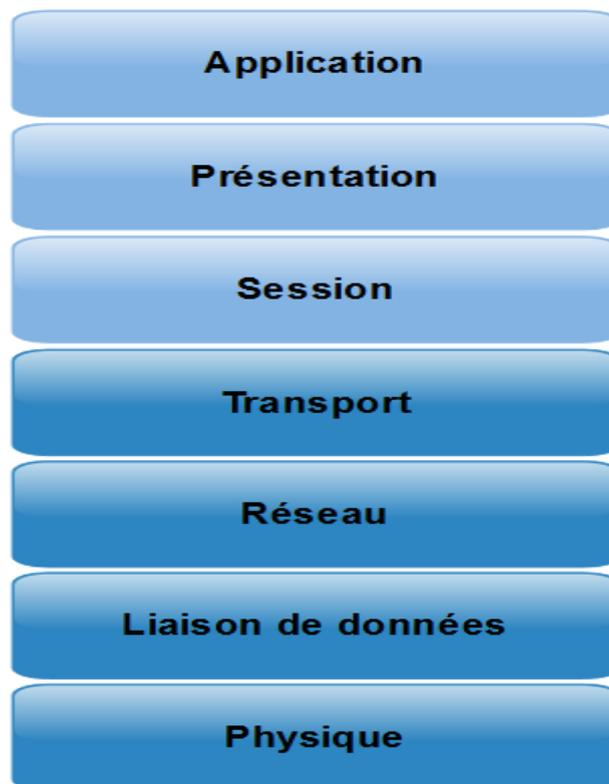
Figure 1.7: les couches du modèle OSI
