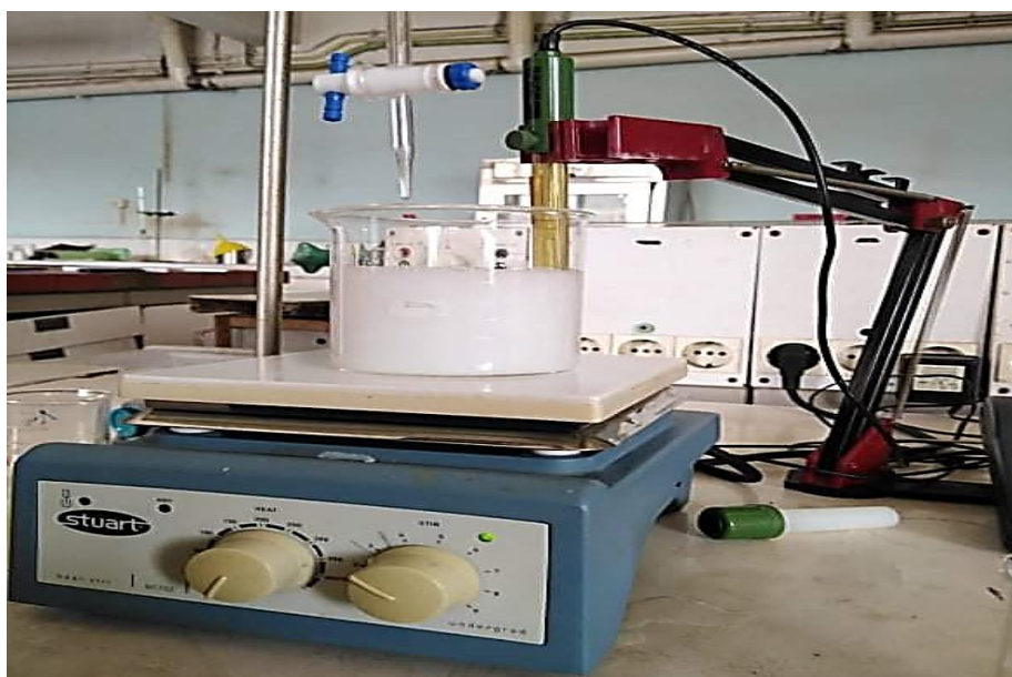
Figure 3.2. Montage expérimental de préparation de l'HDL
