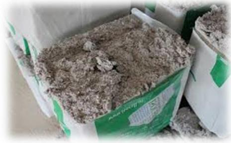
Figure 12 : La ouate de cellulose en vrac
