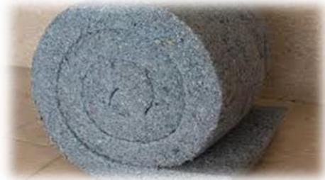
Figure 13 : Rouleaux en coton recyclé
