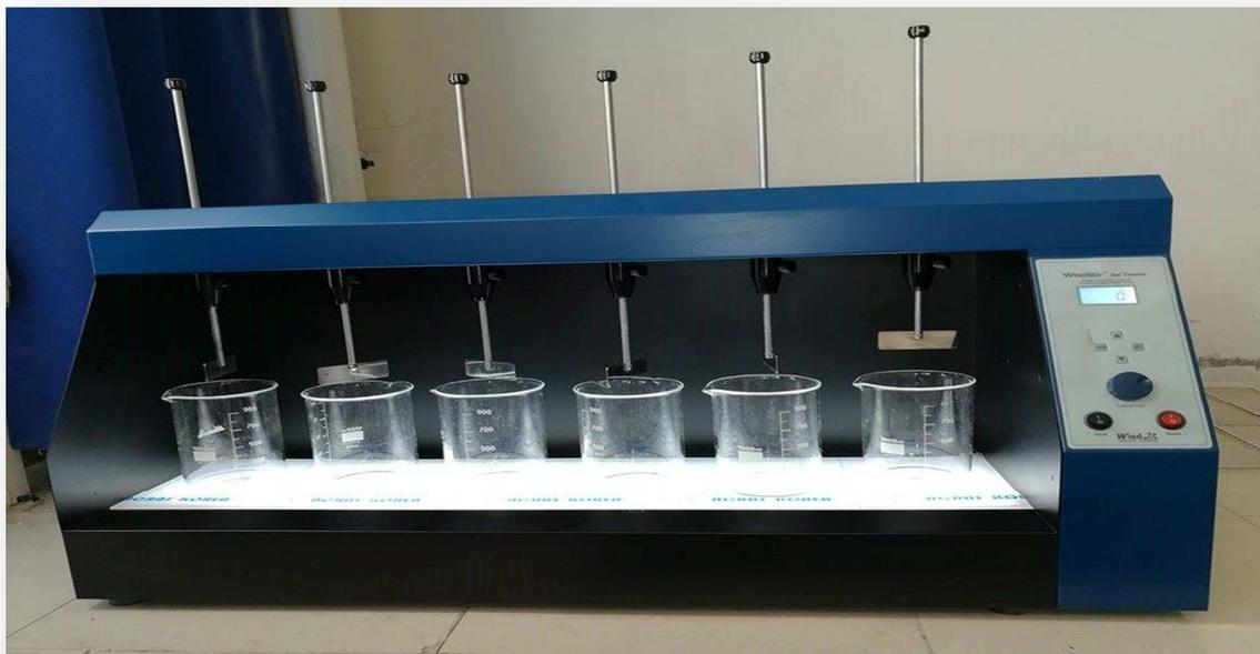
**Figure 22:** le dispositif expérimental (Jar test).
