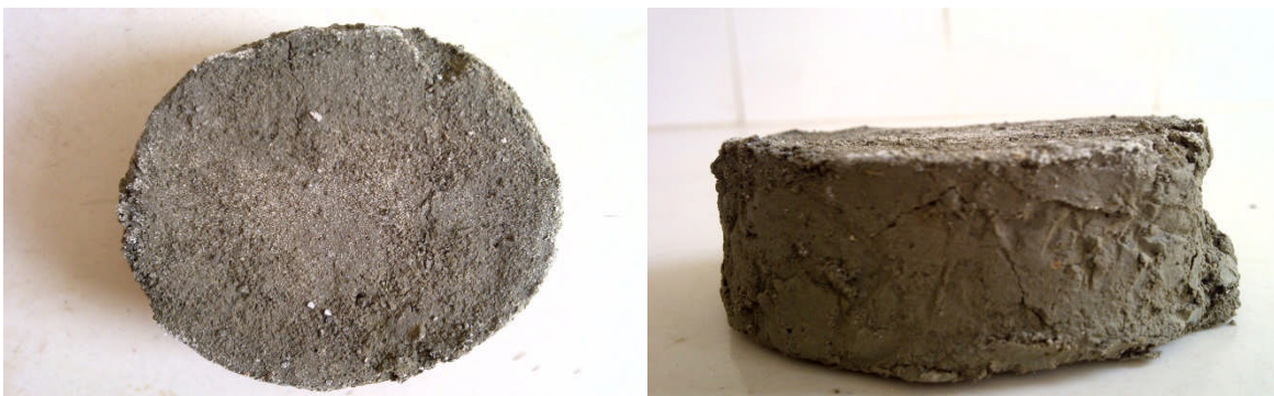
Figure V-12 : Echantillon témoin après 10 cycles de Gel-Dégel.
