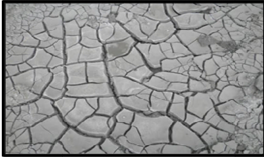
Figure III-18 : Dessiccation de la marne.
