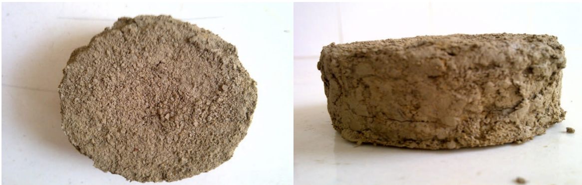
Figure V-36 : Echantillon 2 après 10 cycles de Gel-Dégel.
