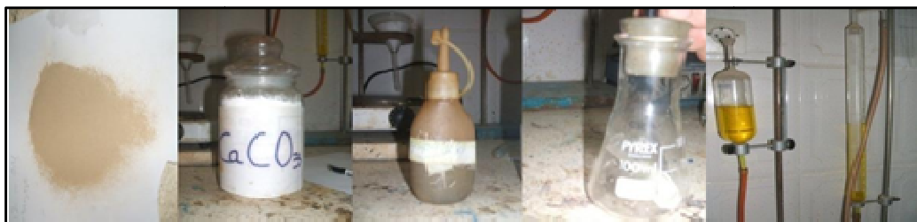
Figure IV-29: Principaux étapes de la méthode de calcimètre.
