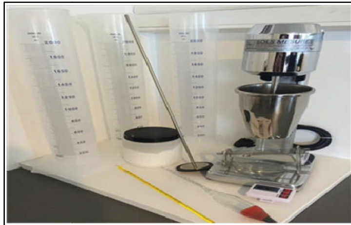
Figure IV-11: Matériel d'essai d'analyse granulométrique par sédimentométrie.
