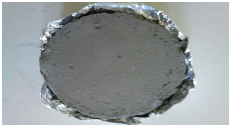
Figure V-43 : Echantillon témoin après 5 cycles de Gel-Dégel.
