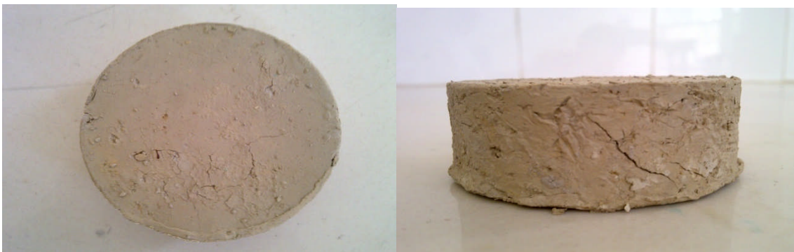
Figure V-37 : Echantillon témoin à 48h après l'essai.
