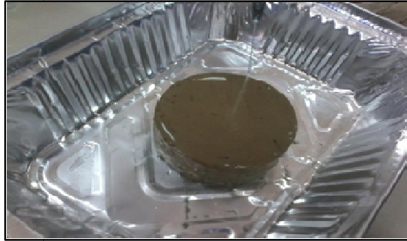
Figure V-56: Saturation des échantillons à l'aide d'une seringue.
