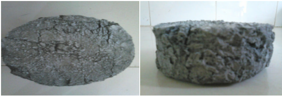
Figure V-64 : Marne de DEM après le 2 ème cycle.
