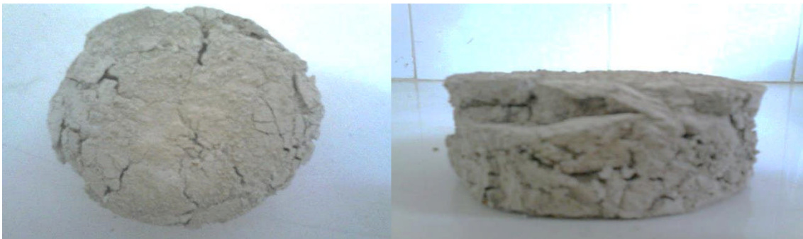
Figure V-69 : Marne de Dely Ibrahim après le 2 ème cycle.
