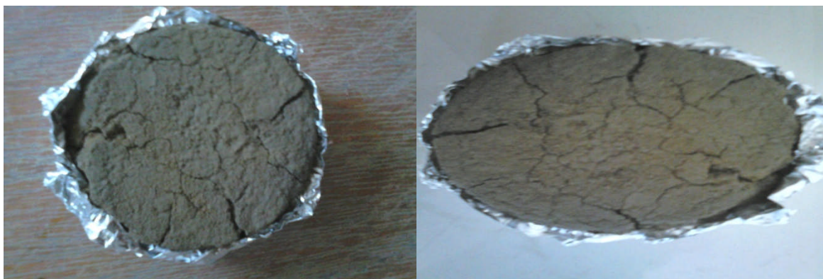
Figure V-33 : Echantillon 1-2 après 5 cycles de Gel-Dégel.
