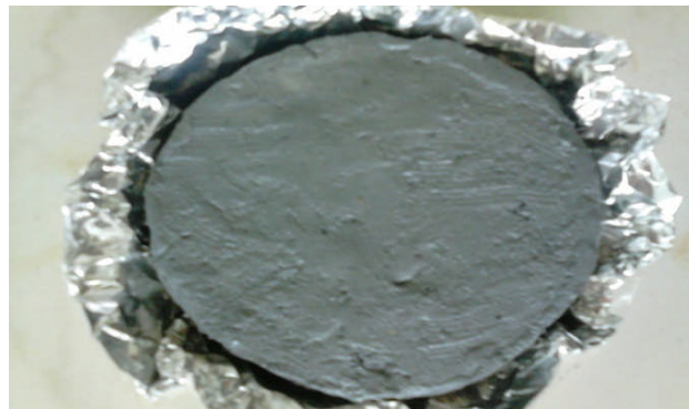
Figure V-21 : Echantillon témoin après 5 cycles de Gel-Dégel.
