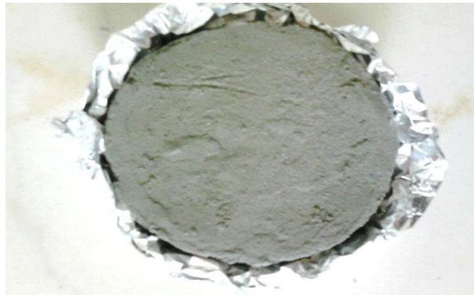
Figure V-10 : Echantillon témoin après 5 cycles de Gel-Dégel.
