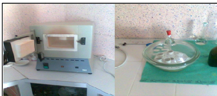
Figure IV-30: Détermination de la teneur pondérale en matières organiques.
