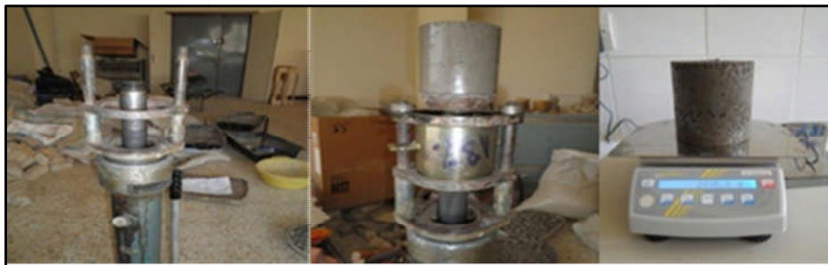
Figure V-3 : Etape de démoulage du moule Proctor.
