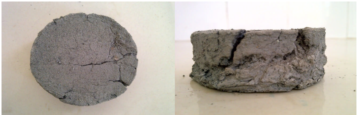
Figure V-24: Echantillon 1 après 10 cycles de Gel-Dégel.
