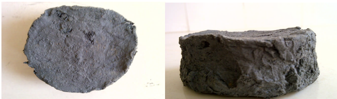
Figure V-23 : Echantillon témoin après 10 cycles de Gel-Dégel.
