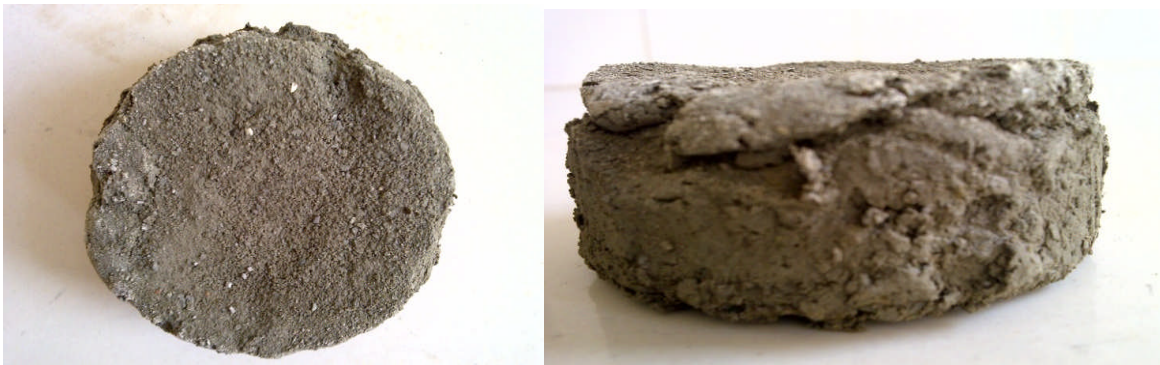
Figure V-14 : Echantillon 2 après 10 cycles de Gel-Dégel.
