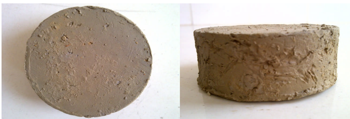
Figure V-34 : Echantillon témoin après 10 cycles de Gel-Dégel.
