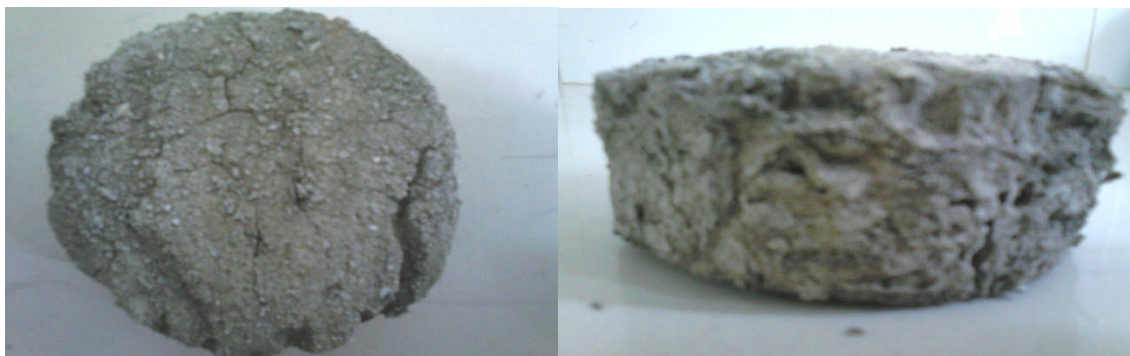
Figure V-59 : Marne de Boghni après le 2 ème cycle.
