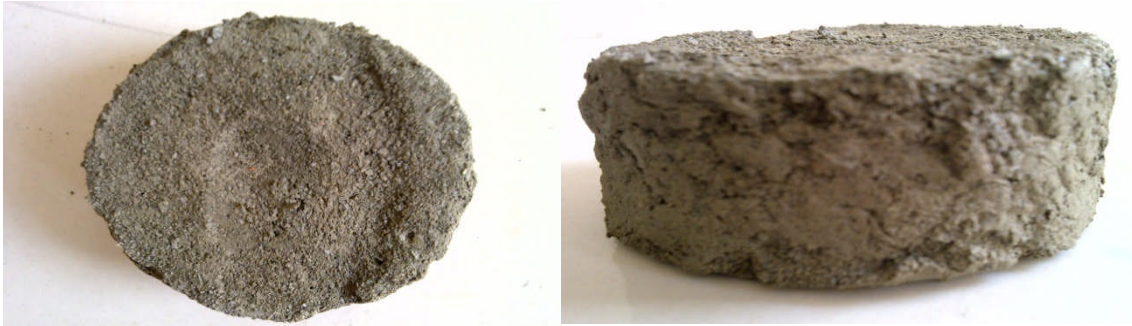
Figure V-13 : Echantillon 1 après 10 cycles de Gel-Dégel.
