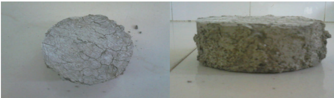
Figure V-58 : Marne de Boghni après le 1 er cycle.
