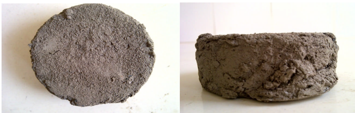
Figure V-47 : Echantillon 2 après 10 cycles de Gel-Dégel.
