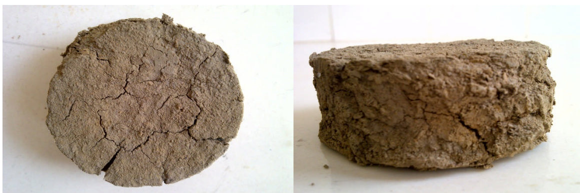
Figure V-35 : Echantillon 1 après 10 cycles de Gel-Dégel.
