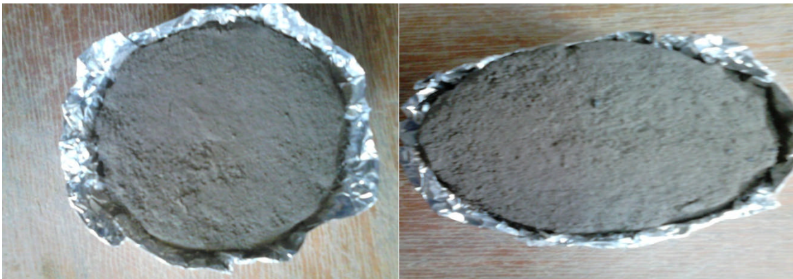
Figure V-44 : Echantillon 1-2 après 5 cycles de Gel-Dégel.
