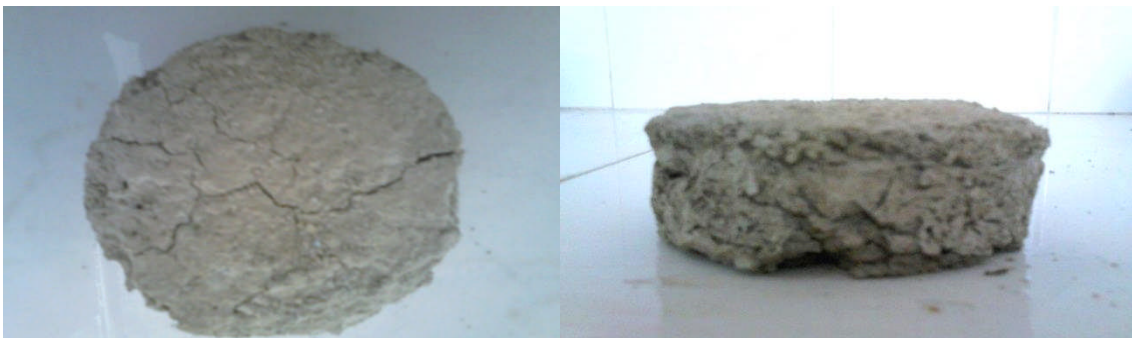
Figure V-70 : Marne de Dely Ibrahim après le 3 ème cycle.
