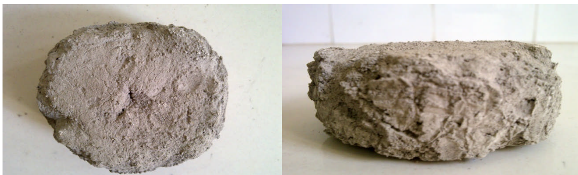
Figure V-76 : Marne Les Chabane après le 4 ème cycle.
