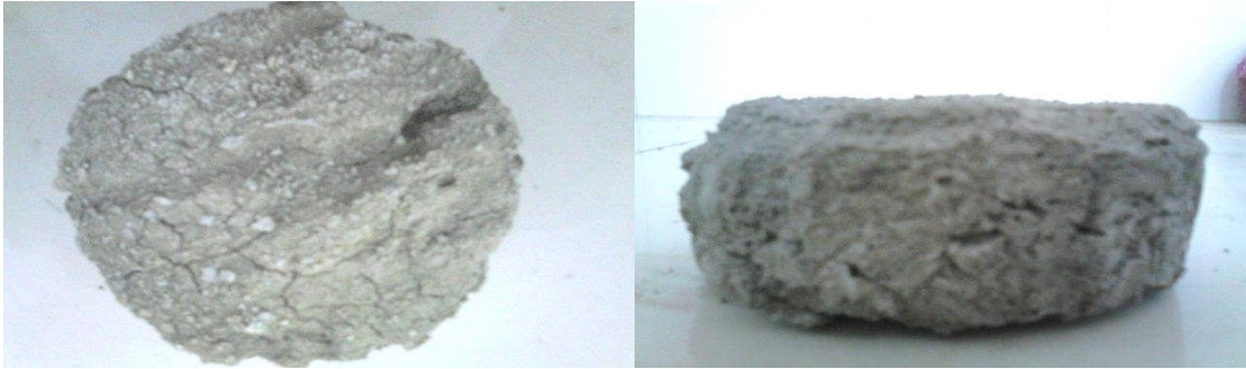
Figure V-60 : Marne de Boghni après le 3 ème cycle.
