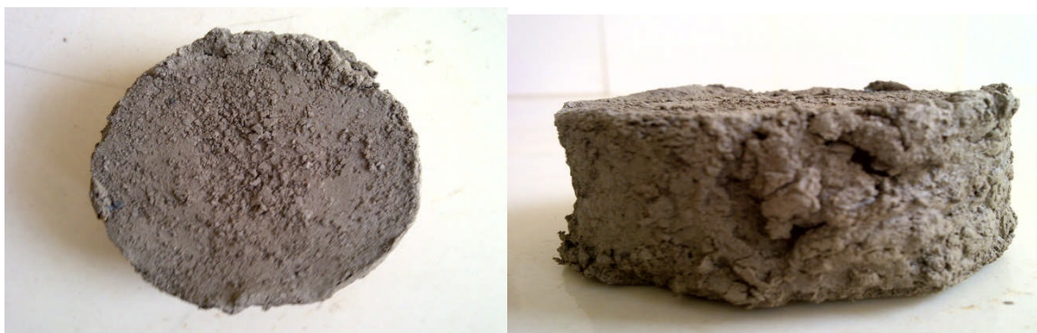
Figure V-45 : Echantillon témoin après 10 cycles de Gel-Dégel.
