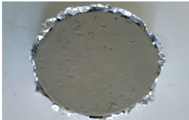
Figure V-32 : Echantillon témoin après 5 cycles de Gel-Dégel.
