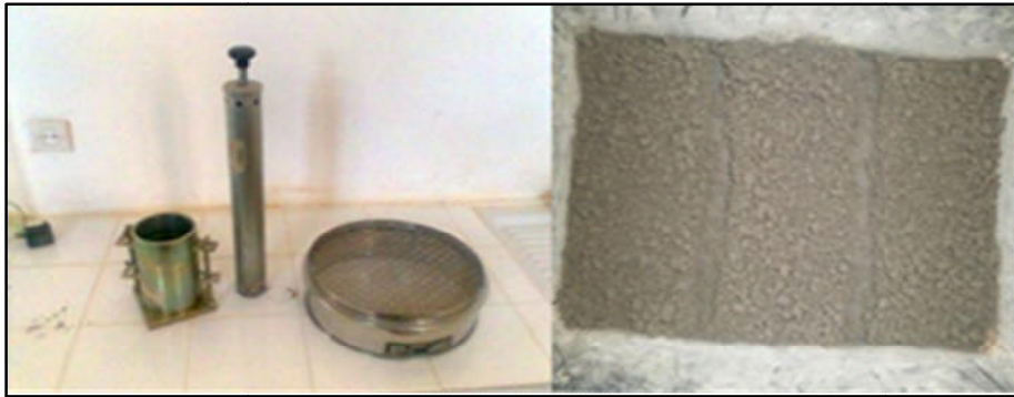
Figure V-2 : Matériel de confection des éprouvettes d'essai Proctor normal.
