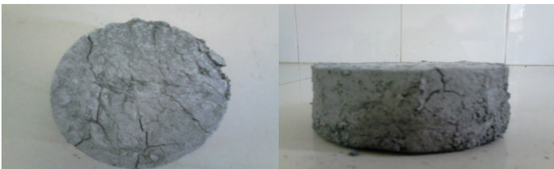
Figure V-63 : Marne de DEM après le 1er cycle.
