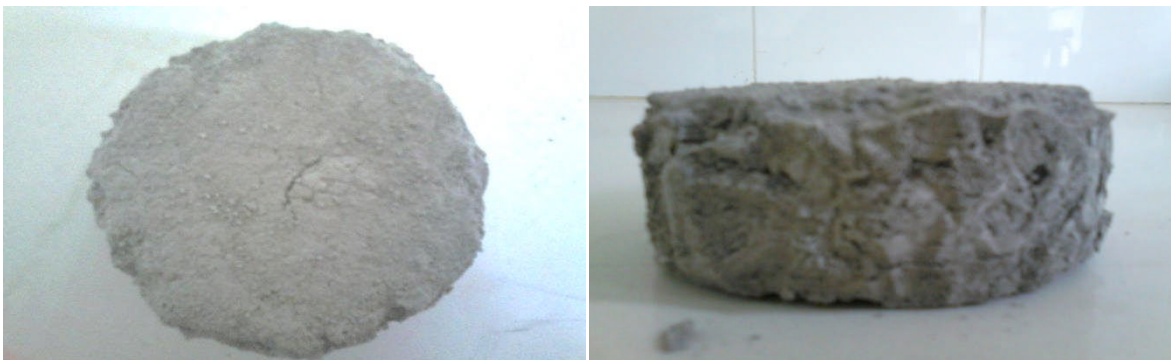
Figure V-74 : Marne Les Chabanes après le 2 ème cycle.
