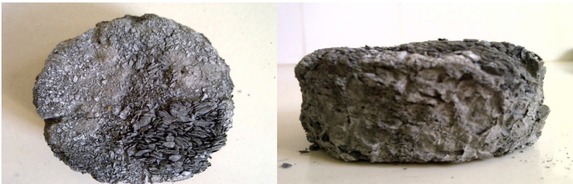
Figure V-66 : Marne de DEM après le 4 ème cycle.
