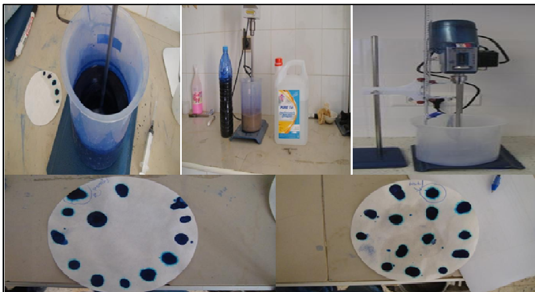
Figure IV-27: Essai au bleu de méthylène (résultats de l'essai à la tâche).
