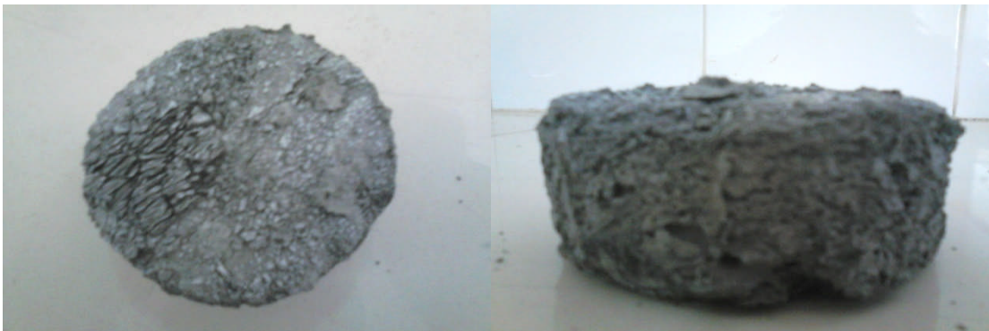
Figure V-65 : Marne de DEM après le 3 ème cycle.
