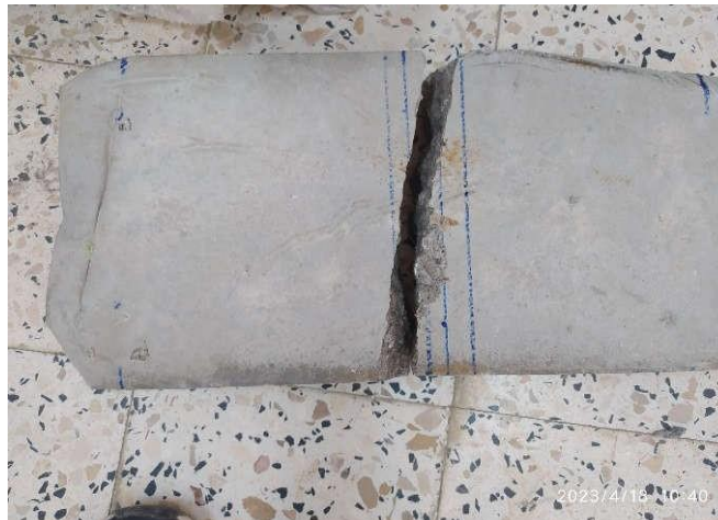
Figure V.11 Mode de rupture du béton témoin BT
