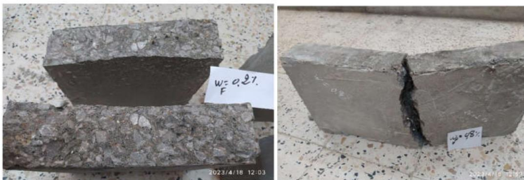
Figure V.5 exemple du mode de rupture des dalles testées lors des essais en flexion 3-point
