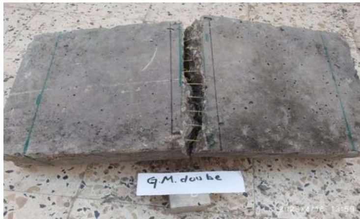
Figure V.15 Mode de rupture de dalles avec des (GPP/GM)
