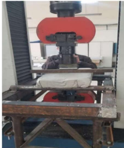
Figure V.4 Exemple d'essai flexion 3-points
