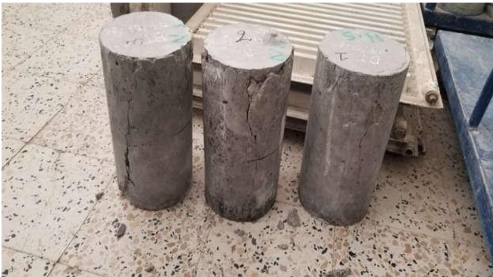
Figure IV.4 Rupture de l'éprouvettes béton témoin sous sollicitation de compression
