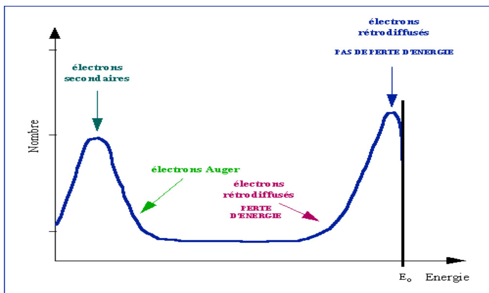
Figure IV-12 : Représentation schématique de l'énergie de distribution des électrons émis par un échantillon[8]
