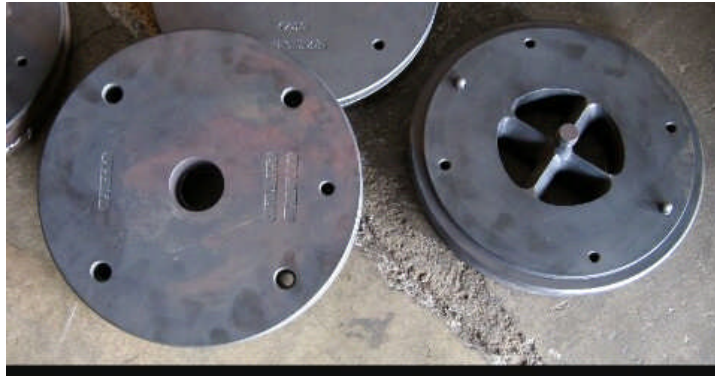
Figure II.7 : filière pour la fabrication des tuyaux pleins ou creux.
