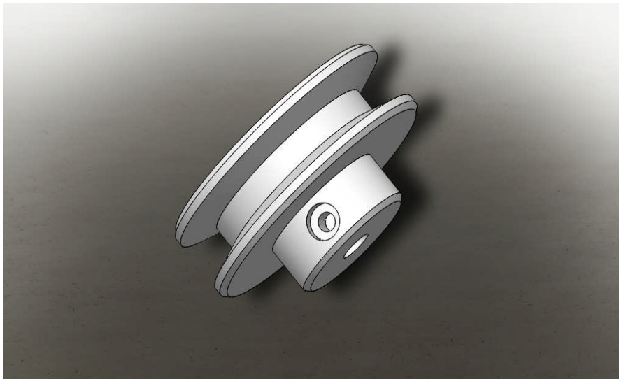
Figure IV.19: modèle CAO de la poulie menante.
