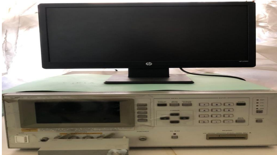
Figure II-10 : Impédance-mètre HP 4284A (20 Hz à 1 MHz).
