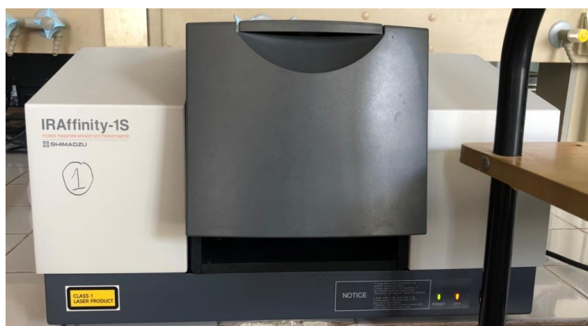
Figure II-7 : Spectroscopie infrarouge à transformée de Fourier (FTIR).
