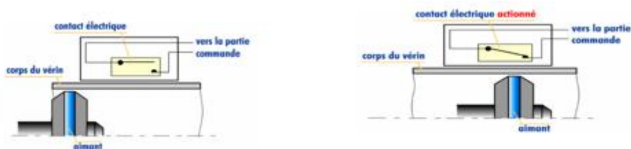
Figure I.15 : Schéma fonctionnel d'un capteur magnétique.
