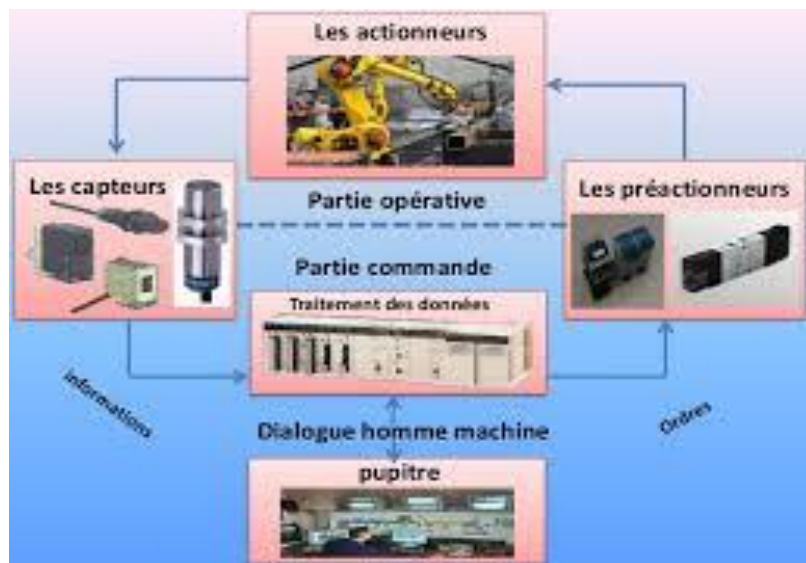
Figure II.1 : Architecture générale des systèmes automatisés.
