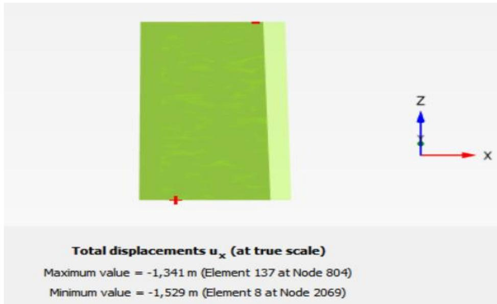
**Figure IV. 18 .** Déplacement  $U_x$  de la plate-forme après sollicitation sismique avec le modèle HSS.
