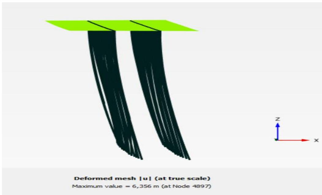
**Figure IV. 7 .** Déformation des pieux et de la plate-forme après la sollicitation sismique en viscoélastique.
