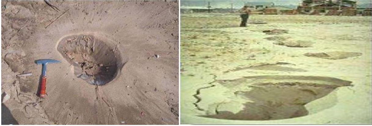
*Figure I. 26. Ebullition de sables, wildlife. Séisme de de supérstition hills californie 1987*
