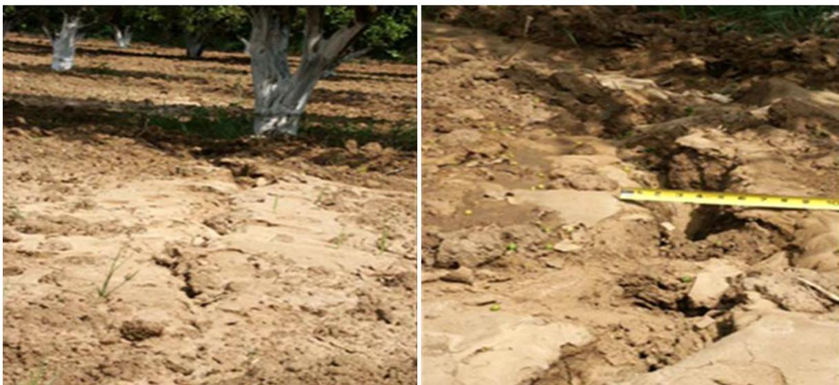
*Figure I. 28. Liquéfaction près de la ville de Zemmouri (ébullitions de sable). Séisme de Boumerdes 2003, (D'après le EERI, 2003)*
