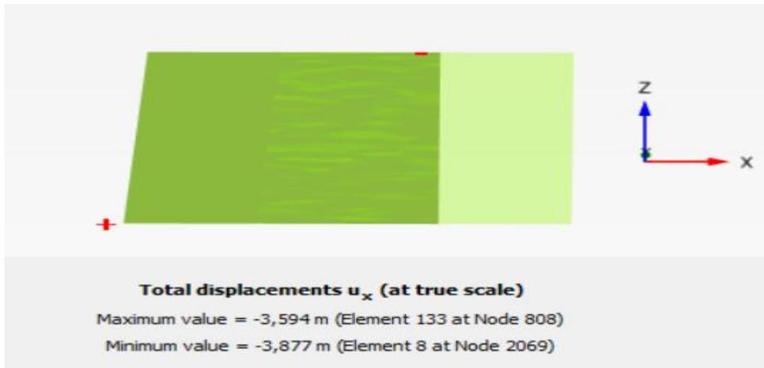
Figure IV. 8 . Déplacement  $U_x$  de la plate forme après la sollicitation sismique en viscoélastique.
