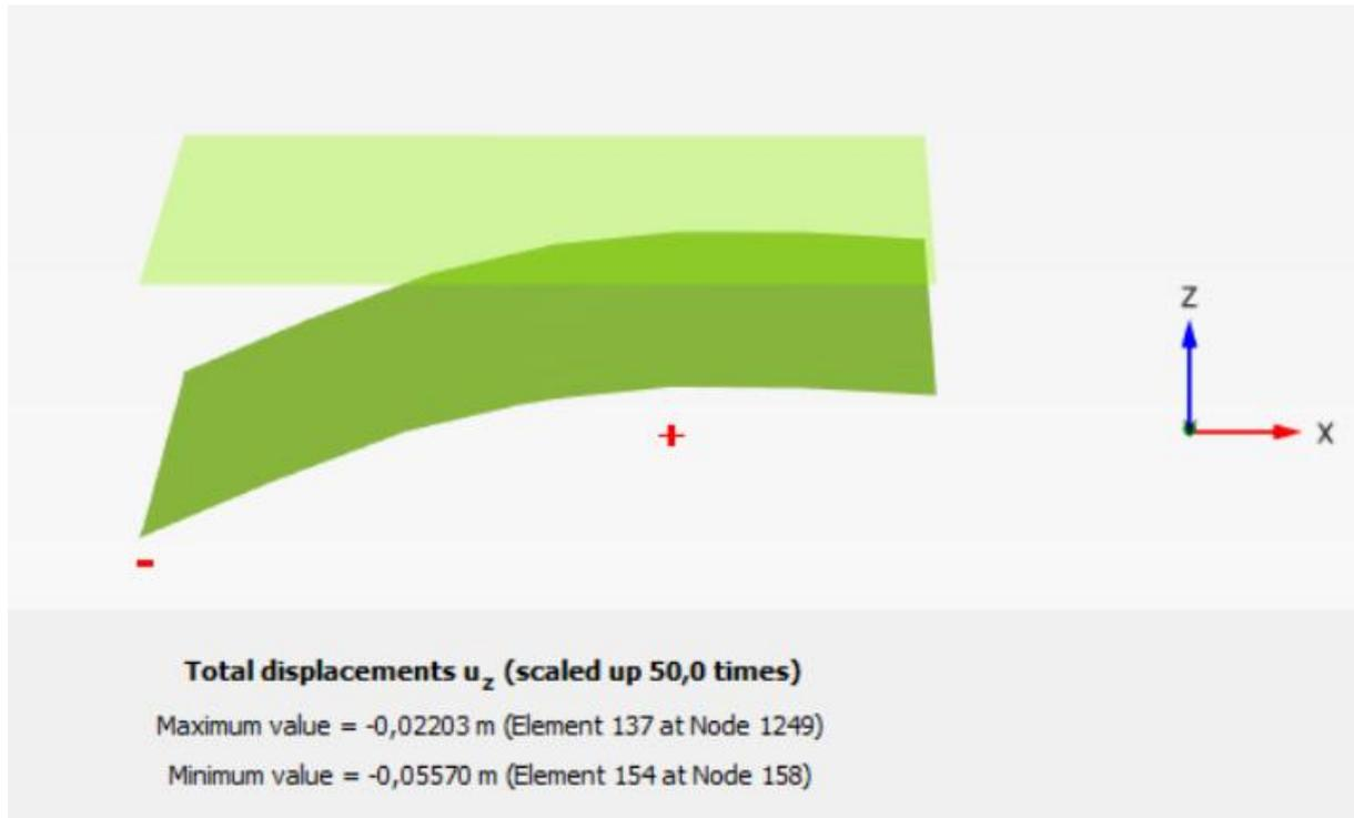
Figure III. 10 . Déplacement  $U_z$  de la plate-forme à l'état statique.
