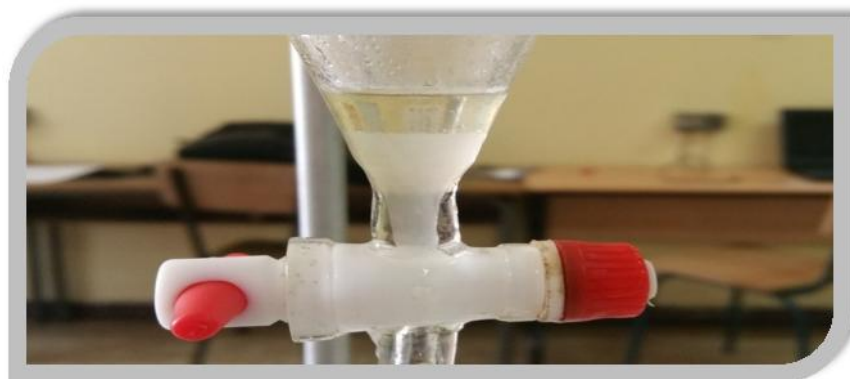
Figure 5 : figure représentative de la séparation des deux phases aqueuse et organique (Décantation) [108]
