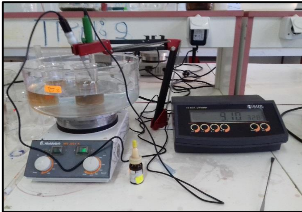
Figure 2. Montage expérimental de traitement des margines par coprécipitation.
