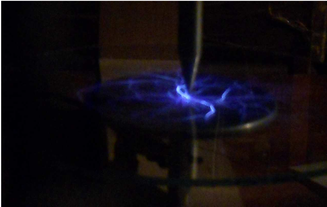
Image 3 : développement de la décharge sur un rayon égale à celui de l'électrode plane
