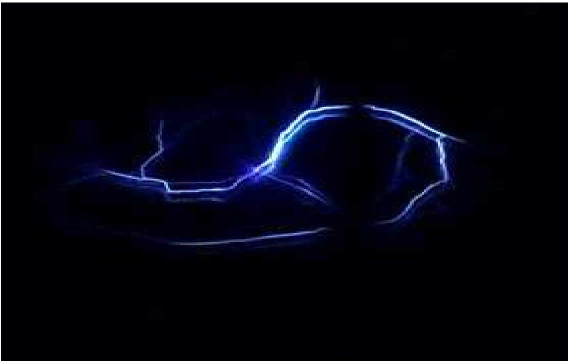
Image 10 : développement de la décharge sur une surface du rayon égale à celui de l'électrode mise à la terre (plane).
