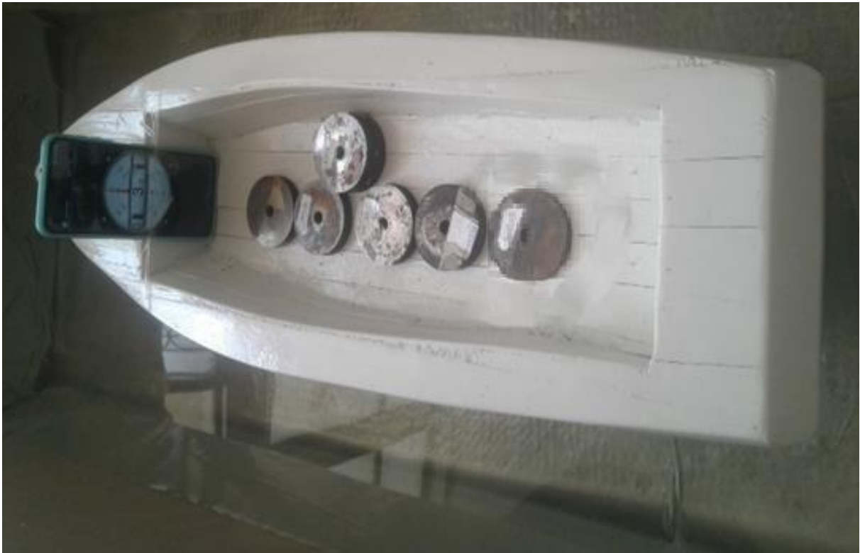
Figure III-27 : Sixième essai expérimental pour le calcul de la stabilité transversal ( \alpha= 3,1^\circ )
