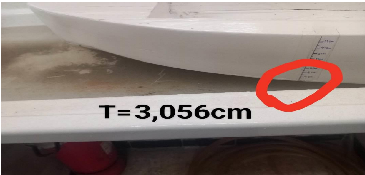
Figure III-19 : Confirmation de tirant d'eau.
