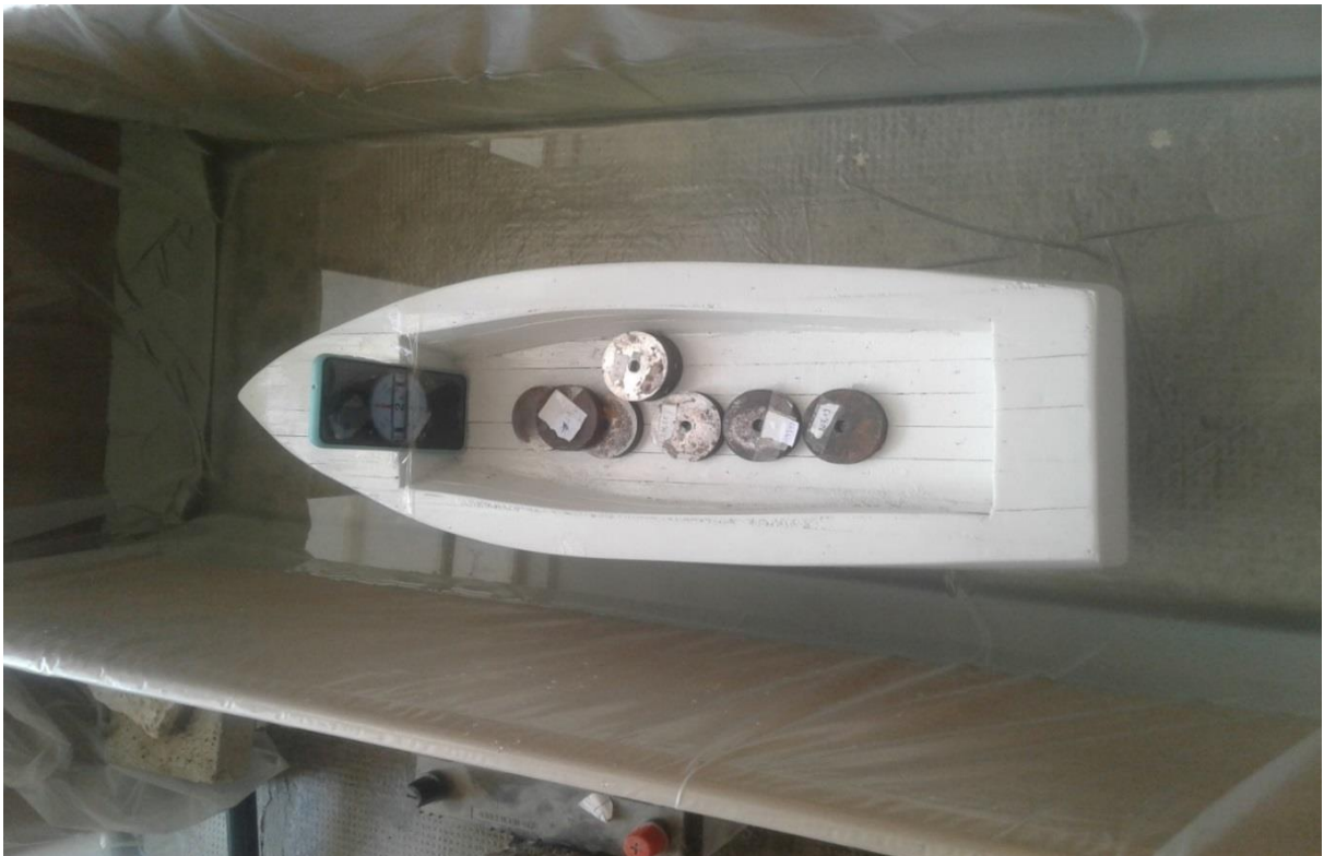
Figure III-28 : Septième essai expérimental pour le calcul de la stabilité transversal ( \alpha= 2,7^\circ )
