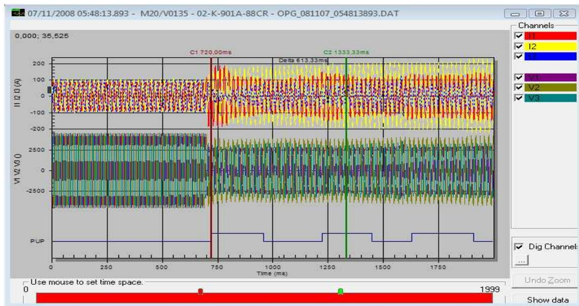
**Figure IV.9 :** Enregistrement de l'oscilloperturbographie dans la sous station 23
