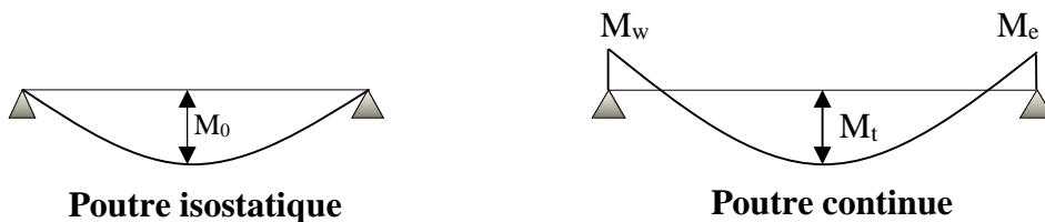
Fig III.2.3 : Diagramme des moments (principe de la méthode forfaitaire)
