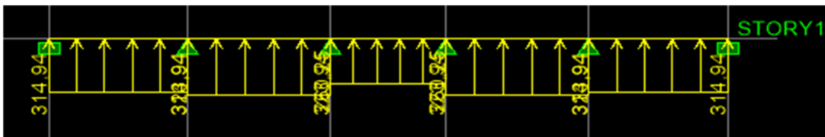
Figure VIII-10 : Schéma statique de la nervure ELS (sens longitudinal).
