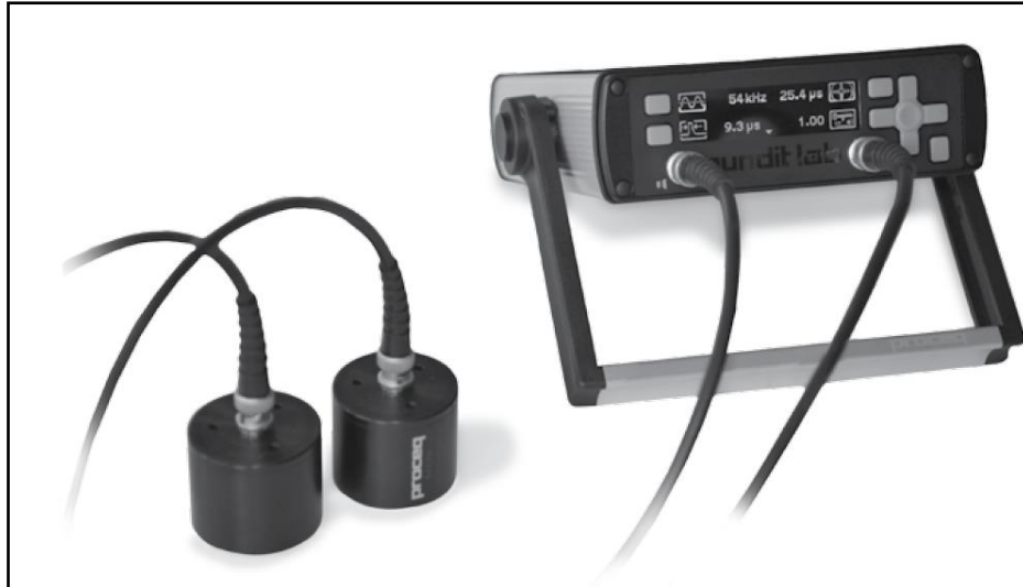
Figure I.13 : Appareil d'auscultation sonore punditLab [24]
