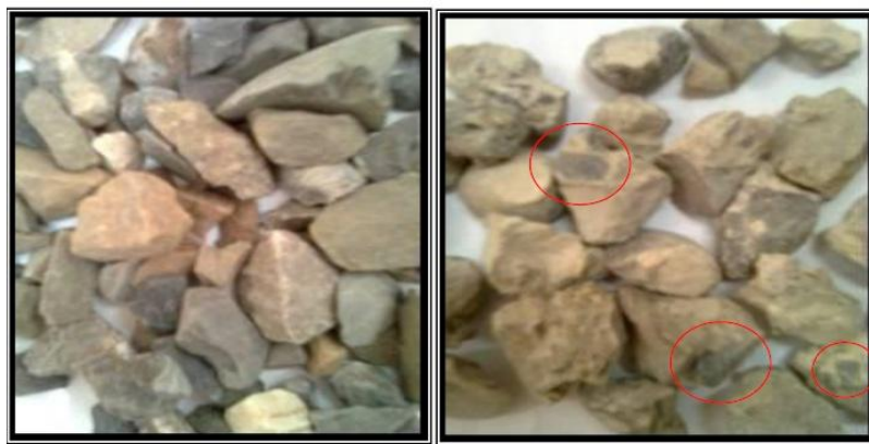
Figure II- 3 : granulats naturels (gauche), granulats de béton de démolition (droite).
