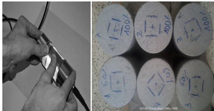
Figure III-3 : calibration de l'appareil, marquage des points d'essai
