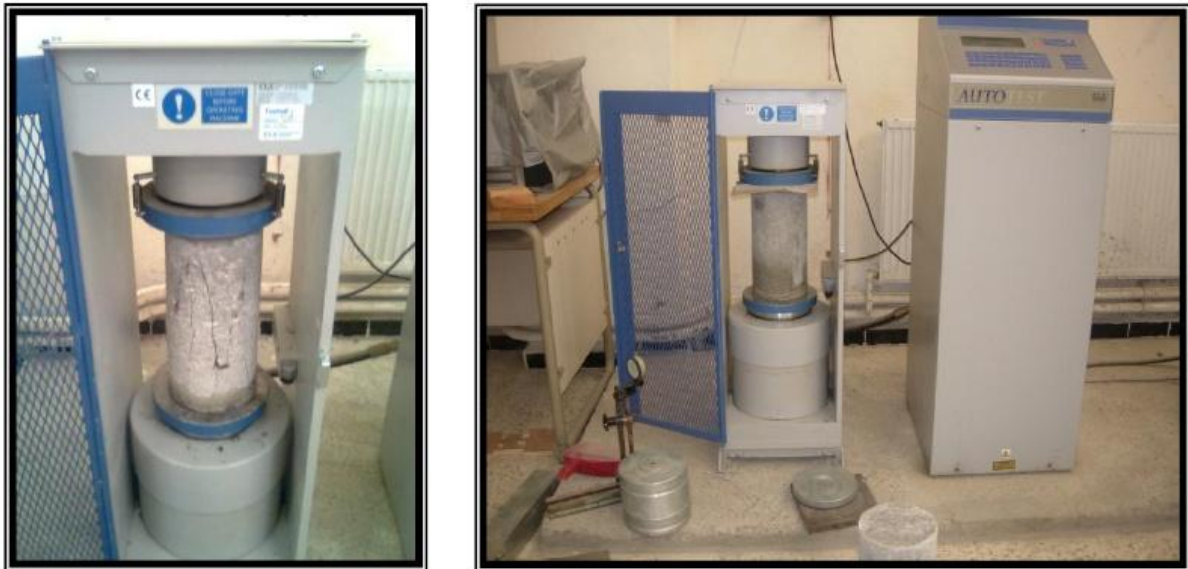
Figure III- 2 : Rupture de l'éprouvette ; La presse utilisée.
