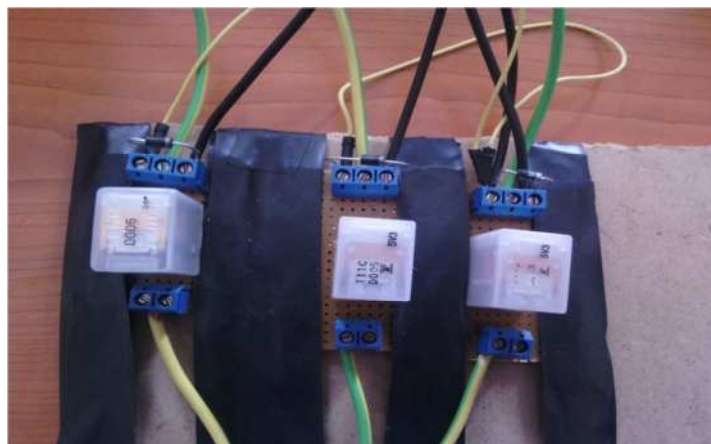
Figure (III-17) : Les modules des relais
