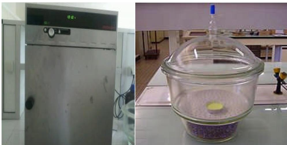
**Figure 11 :** photographie :- à gauche d'une étuve réglable à  $103^{\circ}\text{C}$
