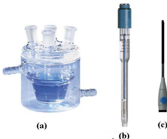
Figure II.3. a) Cellule électrochimique, b) électrode de référence et c) contre électrode.
