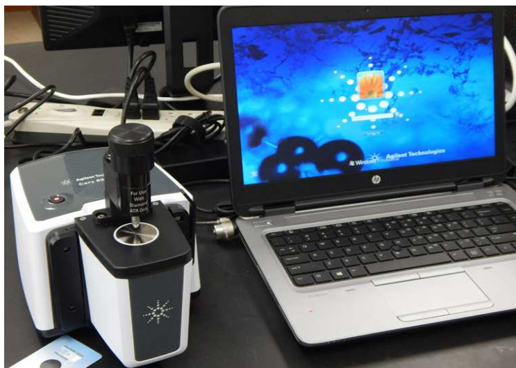
Figure II.9. Spectromètre FTIR Agilent 630 utilisé dans cette étude
