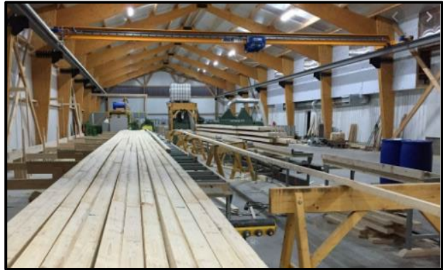
Figure195: Fabrication de poutres en bois lamellé collé
