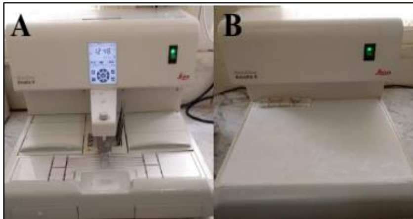
Figure 16 : Appareil d'inclusion (A) ; Solidification des échantillons sur une plaque refroidissante (B). ( Images 2024 )
