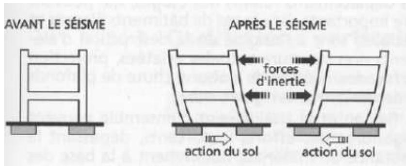
**Figure I. 18 : Oscillations horizontales.**
