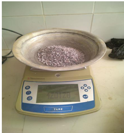
Figure IV.8 : Refus obtenu de l'essai Micro-Deval après séchage
