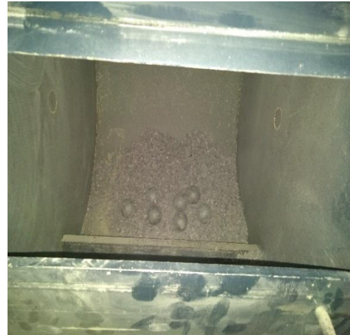
Figure IV.7 : Introduction du matériau et charges dans la machine Los Angeles
