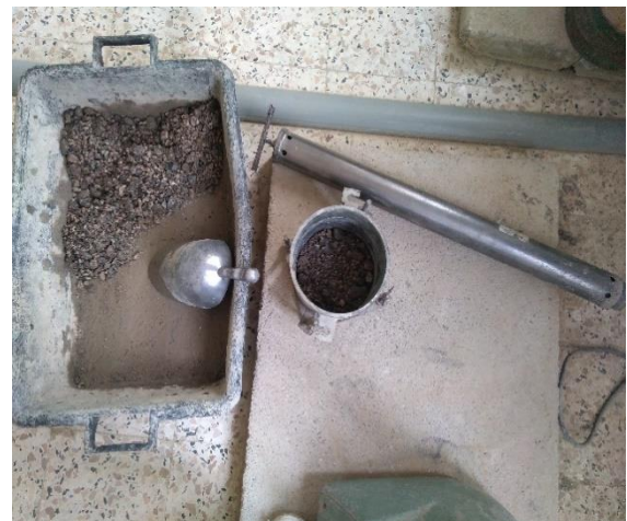
Figure V.3 : Exécution du compactage.
