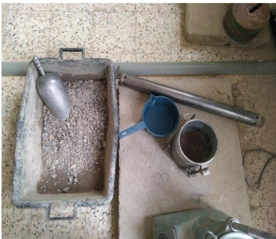
Figure V.2 : Matériel et matériau du compactage.
