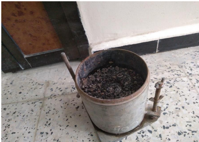
Figure V.9: Eprouvette après poinçonnement.
