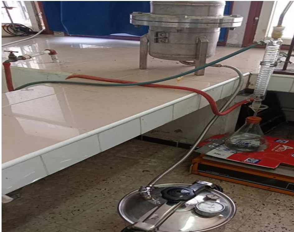
Figure 09: Dispositif d'extraction d'huile essentielle par entrainement à la vapeur d'eau (laboratoire de Biochimie Analytique et Biotechnologie, 2022).
