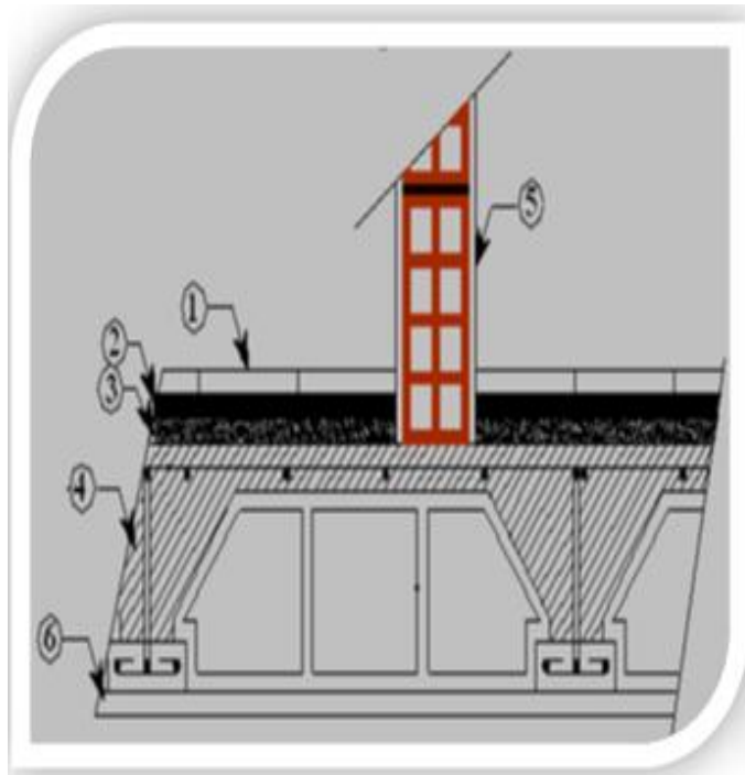
Figure 2-3: Coupe transversale du plancher d'étage courant
