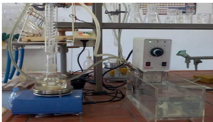
Figure III.1: Dispositif expérimental utilisé pour réaliser la réaction de Knoevenagel
